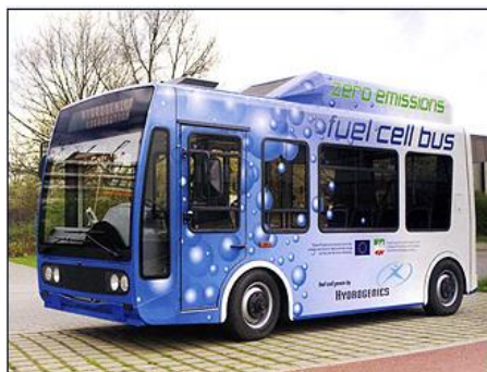
Σχήμα 2.9: Μοντέλο λεωφορείου που χρησιμοποιεί κυψέλες καυσίμου τύπου PEMFCs [30].
