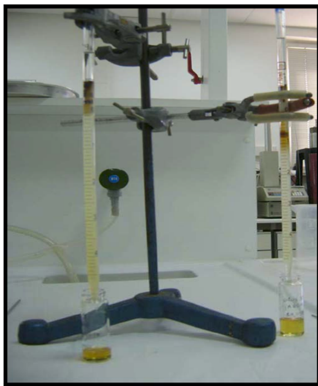
Σχήμα 4. 9: : Χρωματογραφία ανοιχτής στήλης (Εργαστήριο Ανάλυσης Πορήνων και Υπόγειων Ταμιευτήρων)
