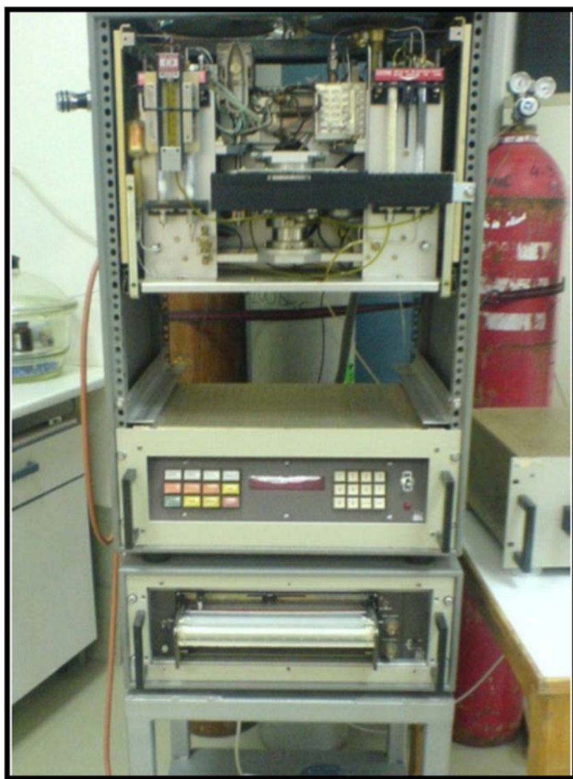
Σχήμα 4. 1: Αναλυτικό σύστημα Rock-Eval II/TOC V1-4 (Εργαστήριο Ανάλυσης Πυρήνων και Ρευστών Υπόγειων Ταμιευτήρων)
