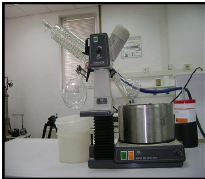
Σχήμα 4. 7: Περιστροφικός Εξατμιστήρας (Εργαστήριο Ανάλυσης Πυρήνων και Υπόγειων Ταμιευτήρων)
