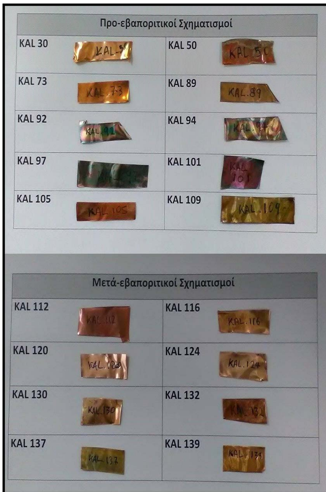
Σχήμα 4. 6: Ελάσματα χαλκού για τα δείγματα των προ-εβαποριτικών και μετά-εβαποριτικών σχηματισμών.
