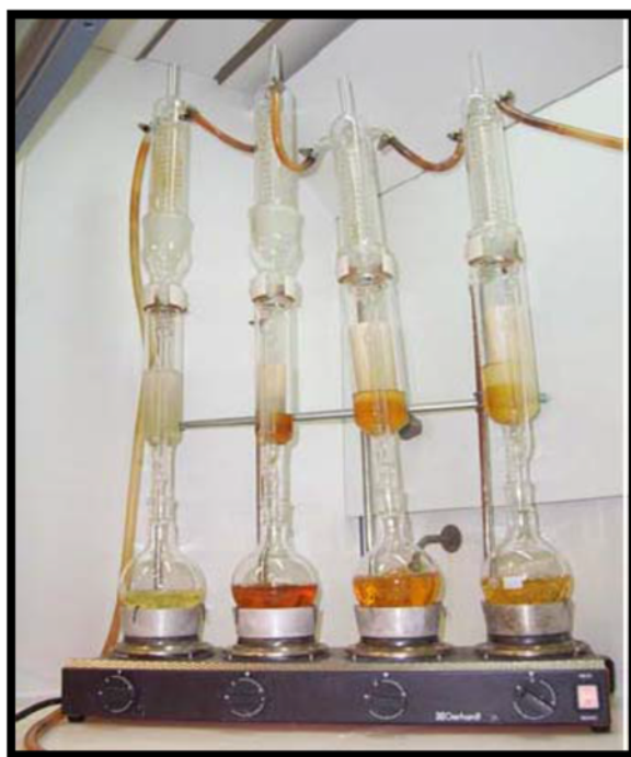
Σχήμα 4. 5: Διάταξη συσκευών Soxhlet (Εργαστήριο Ανάλυσης Πυρήνων και Υπόγειων Ταμιεντήρων)
