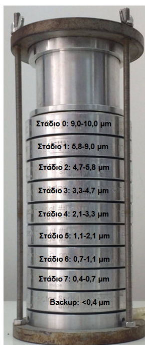
Εικόνα 25: Διαχωριστής πρόσκρουσης σωματιδίων οκτώ σταδίων (Andersen impactor).
