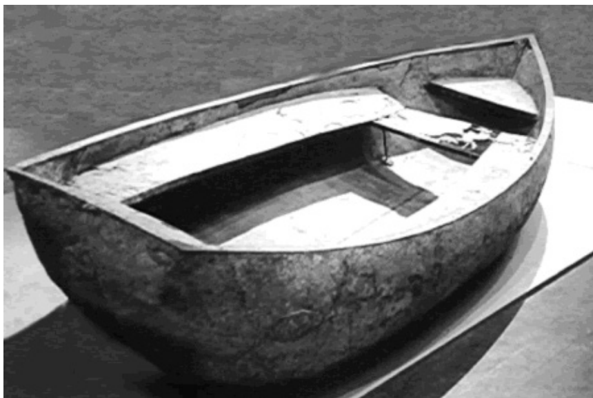
Εικ.50. Βάρκα από μπετόν - αρμέ. Lambot, 1854.
