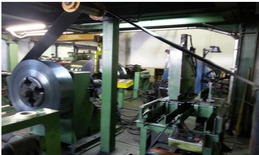
Εικόνα 4.14 Ξετύλιγμα coil στην ανέμη της Γραμμής 4
