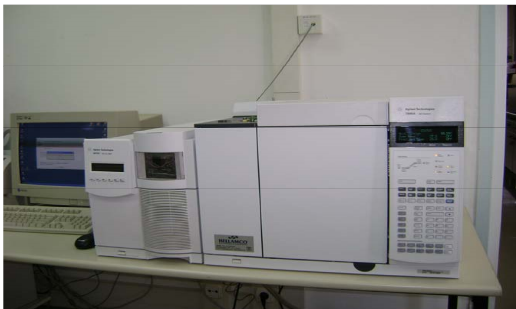
Εικόνα 3.3-1 Αέριος χρωματογράφος-Φασματογράφος μάζας HP 7890/5973 της Agilent
