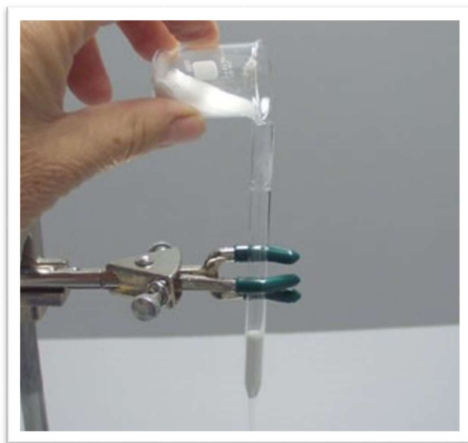
Εικόνα 3.2-1 Εισαγωγή προσροφητικών υλικών στη στήλη
