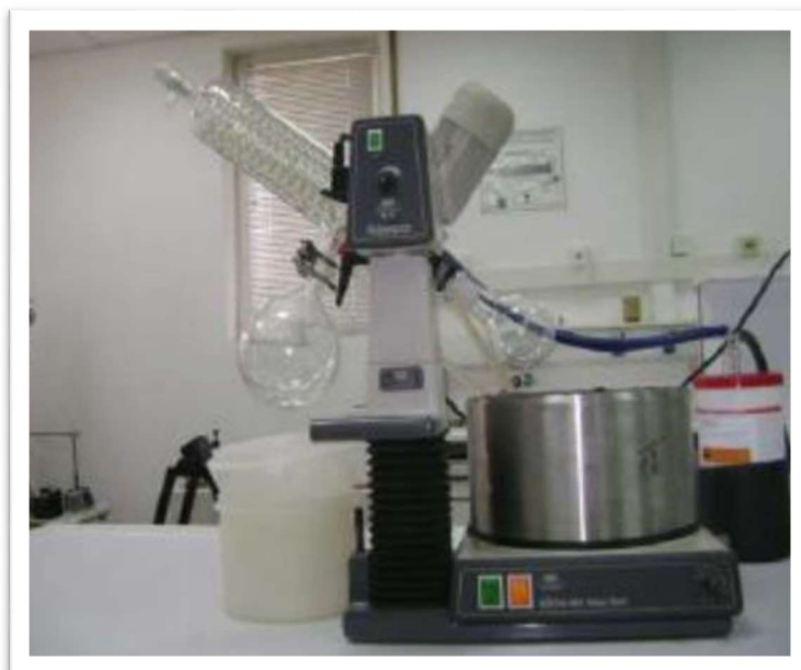
Εικόνα 3.1-1 Περιστροφικός συμπυκνωτής (Εργαστήριο Ανάλυσης Πυρήνων και Υπόγειων Ταμειυτήρων).
