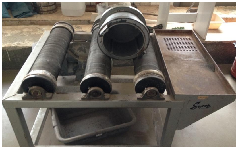
Εικόνα 3.7: Εργαστηριακός Σφαιρόμυλος με το σύστημα περιστροφής.
