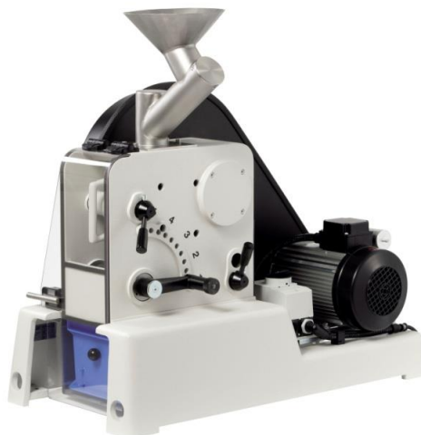
Εικόνα 3.6: Εργαστηριακός Σιαγωνοτός Σπαστήρας.
