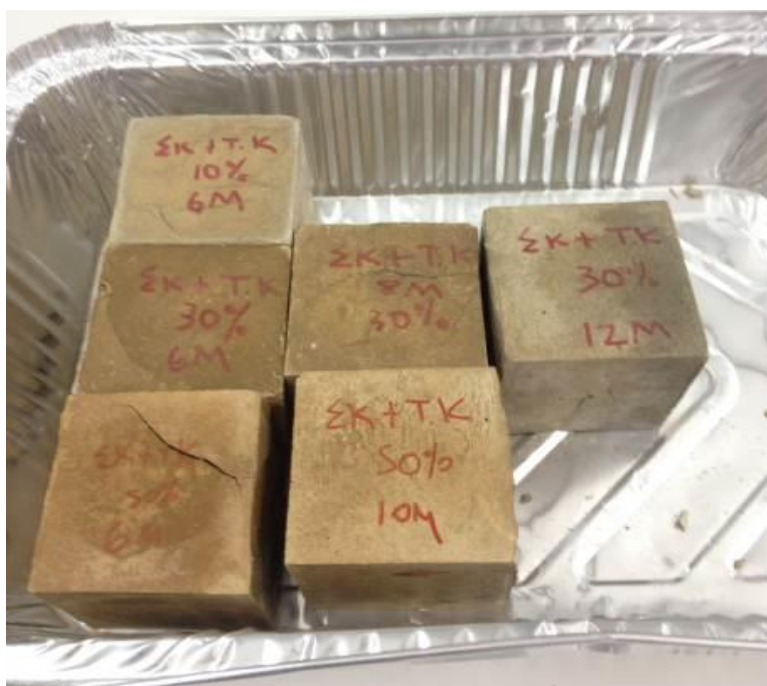
Σχήμα 5.2.4: Τα γεωπολυμερή που προκύπτουν μετά από ανάμιξη τελμάτων Κύπρου και σκυροδέματος.
