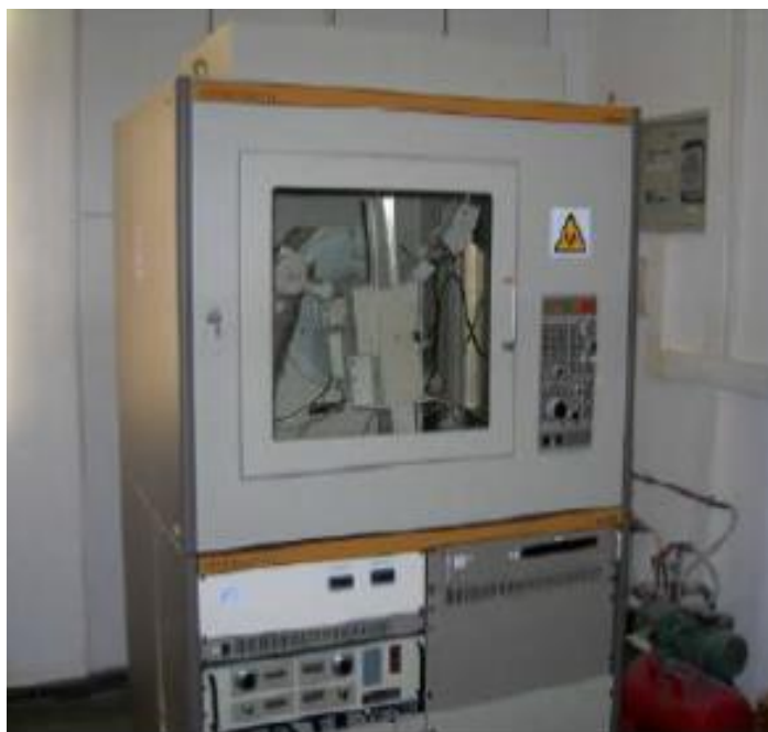
Σχήμα 4.8: Περιθλασίμετρο ακτίνων-X
