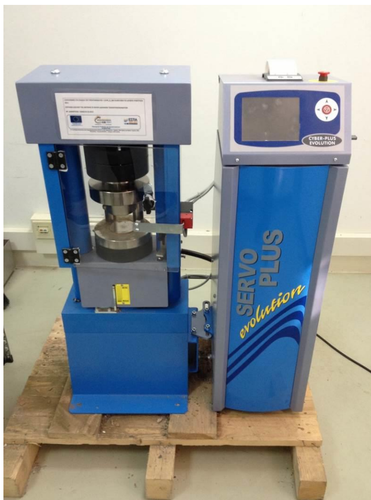
Σχήμα 4.4 : Μηχάνημα μονοαξονικής θλίψης – κονσόλα ελέγχου και καταγραφής δεδομένων.
