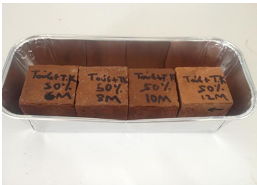
Σχήμα 4.4.2: Γεωπολυμερή από τέλμα χαλκοπυρίτη και τούβλο
