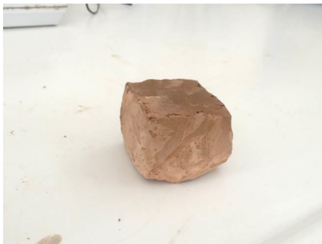
Σχήμα 4.4.1: Γεωπολυμερές στο οποίο οι επιφάνειες έχουν αλλοιωθεί λόγω πειραματικού σφάλματος κατά την παρασκευή του και δεν μπορεί να υποστεί δοκιμή μονοαξονικής θλίψης.
