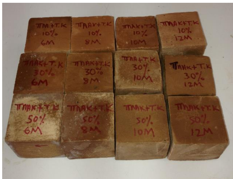
Σχήμα 5.2.3: Τα γεωπολυμερή που προκύπτουν μετά από ανάμιξη τελμάτων Κύπρου και πλακιδίου.
