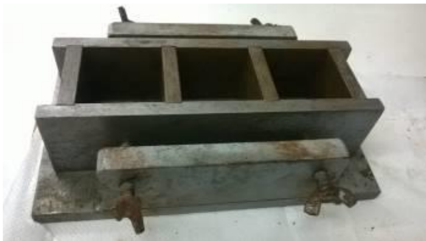
Σχήμα 4.4.1: Μεταλλικές μήτρες χύτευσης γεωπολυμερικού μίγματος.
