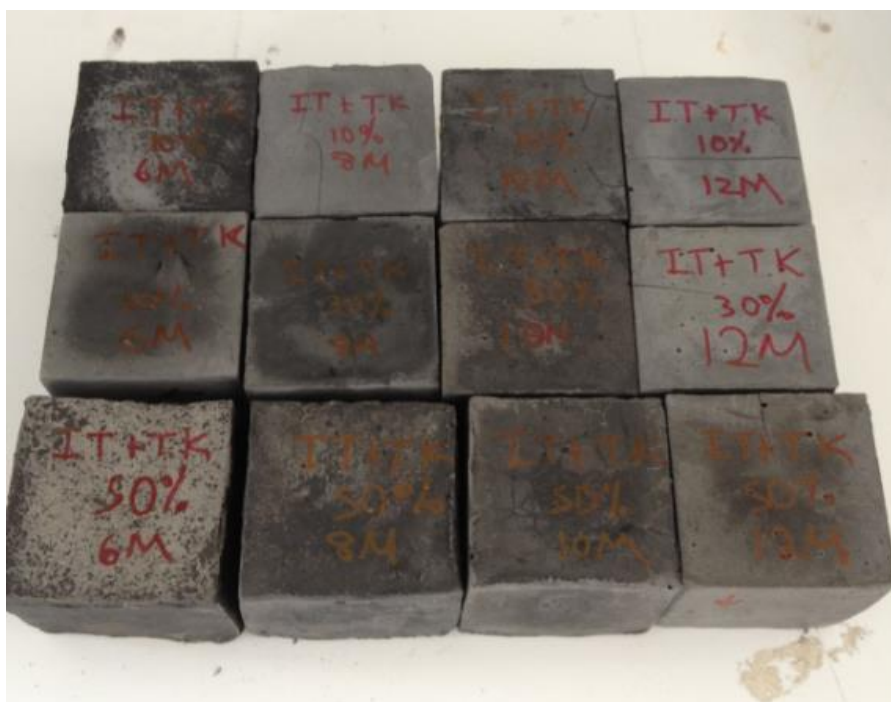
Σχήμα 5.2.5: Τα γεωπολυμερή που προκύπτουν μετά από ανάμιξη τελμάτων Κύπρου και τέφρα Μεγαλόπολης.
