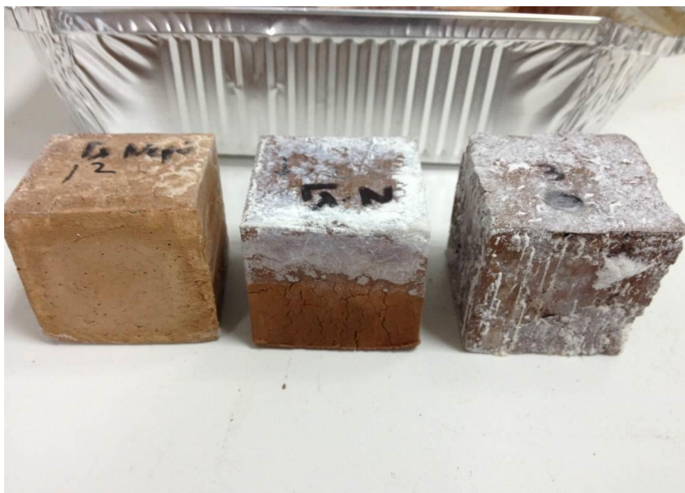
Σχήμα 4.6: Γεωπολυμερή μετά από εμβάπτιση σε απιονισμένο νερό για 1,2,3 μήνες
