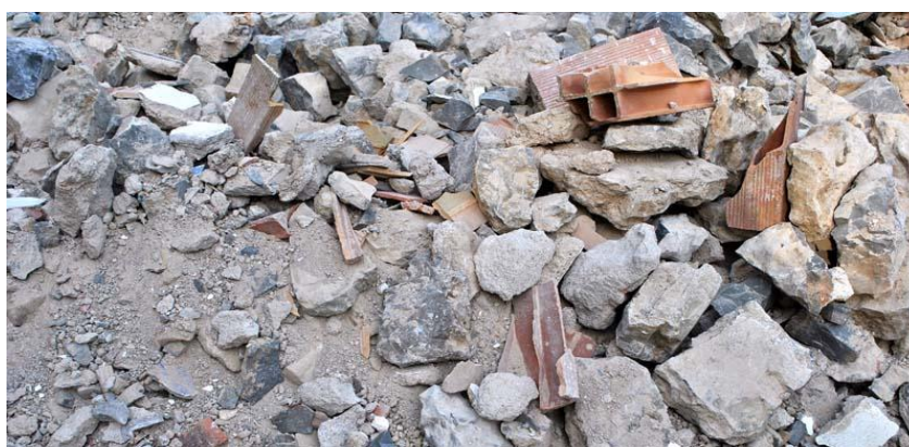
Σχήμα 3.1: Απόβλητα εκσκαφών κατασκευών και κατεδαφίσεων.
