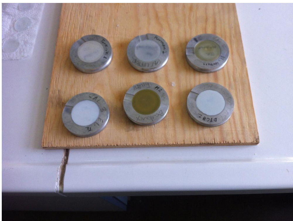
Εικόνα 2.6 Προσανατολισμένα δείγματα έτοιμα για ακτινογράφιση με τη μέθοδο της περιθλασιμετρίας ακτίνων – X (XRD)
