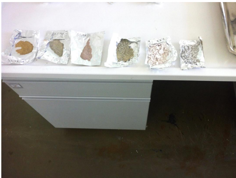
Εικόνα 2.2 Λειοτριβημένα δείγματα σε γουδί με αχάτη
