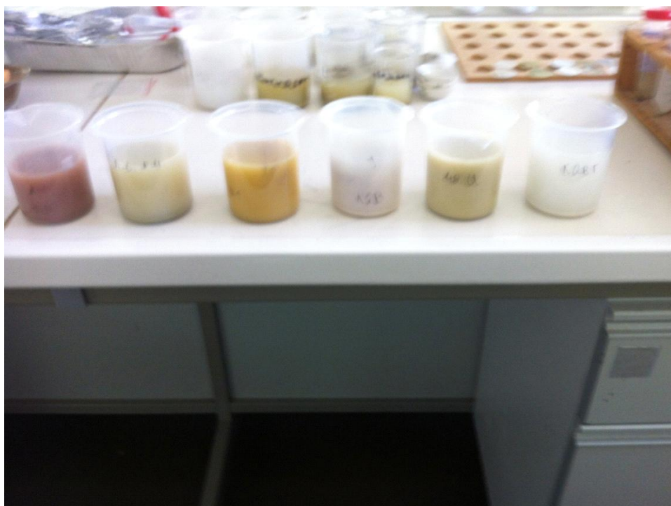
Εικόνα 2.3 Αποχωρισμός του αργλικού κλάσματος
