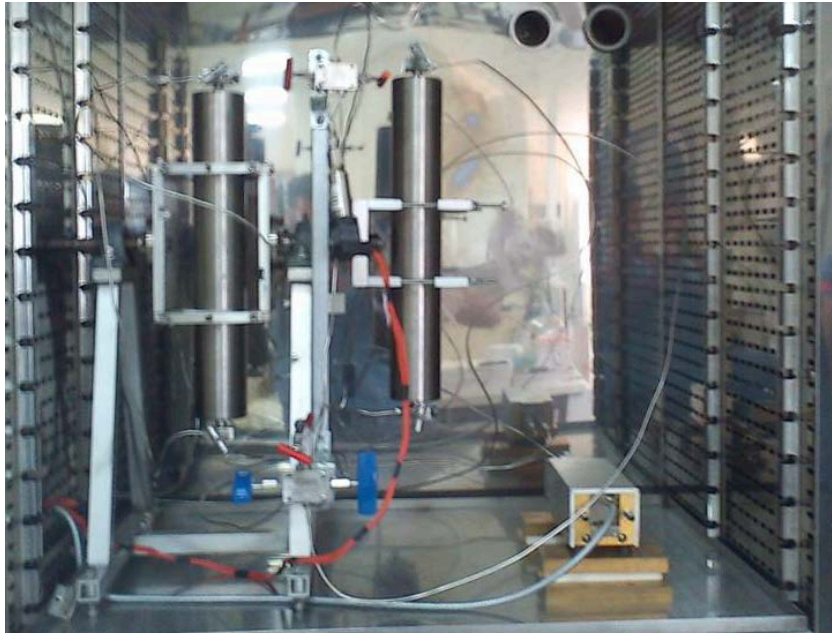
Εικόνα 3.6 Πυκνόμετρο τοποθετημένο εντός του εργαστηριακού κλιβάνου.
