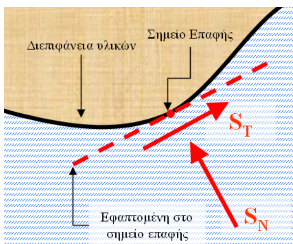
Εικόνα 3.21_ Σύστημα δυνάμεων σε σημείο της διεπιφάνειας διαφορετικών υλικών ή σωμάτων
