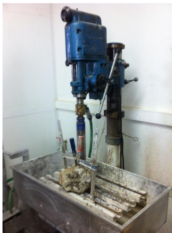
Εικόνα 2.19_σωστή τοποθέτηση δοκιμίου
