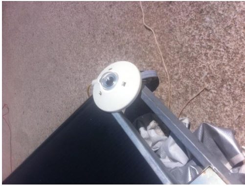
Εικόνα 12 Πυρανόμετρο υπό γωνία
