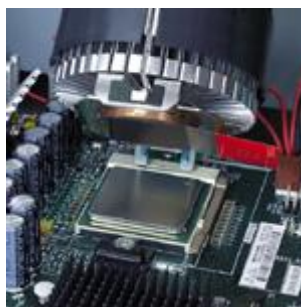
Εικόνα 3: Μικροφίλμ από υλικό αλλαγής φάσης τοποθετημένο πάνω στον επεξεργαστή ηλεκτρονικού υπολογιστή [Bergquistcompany, 2013]
