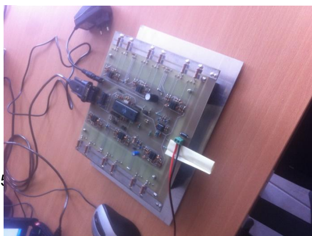
Εικόνα 11 Διάταξη I-V tracer
