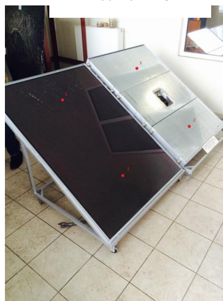
Εικόνα 18 Σημεία μέτρησης θερμοκρασίας
