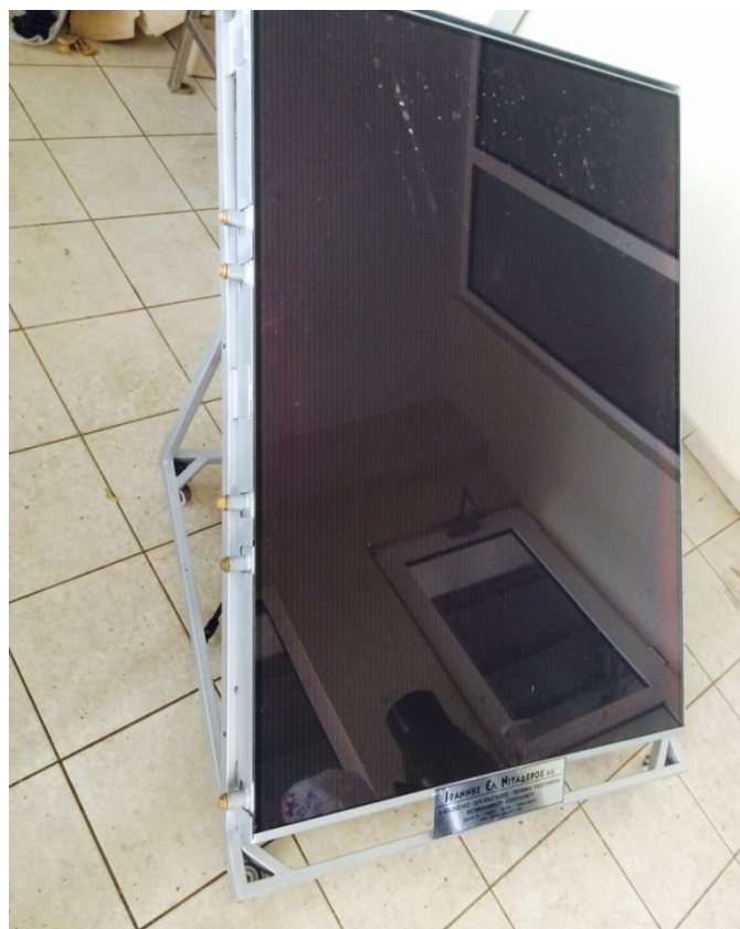
Εικόνα 13: Τα στόμια στο ανώτατο και κατώτατο σημείο του κάθε δοχείου
