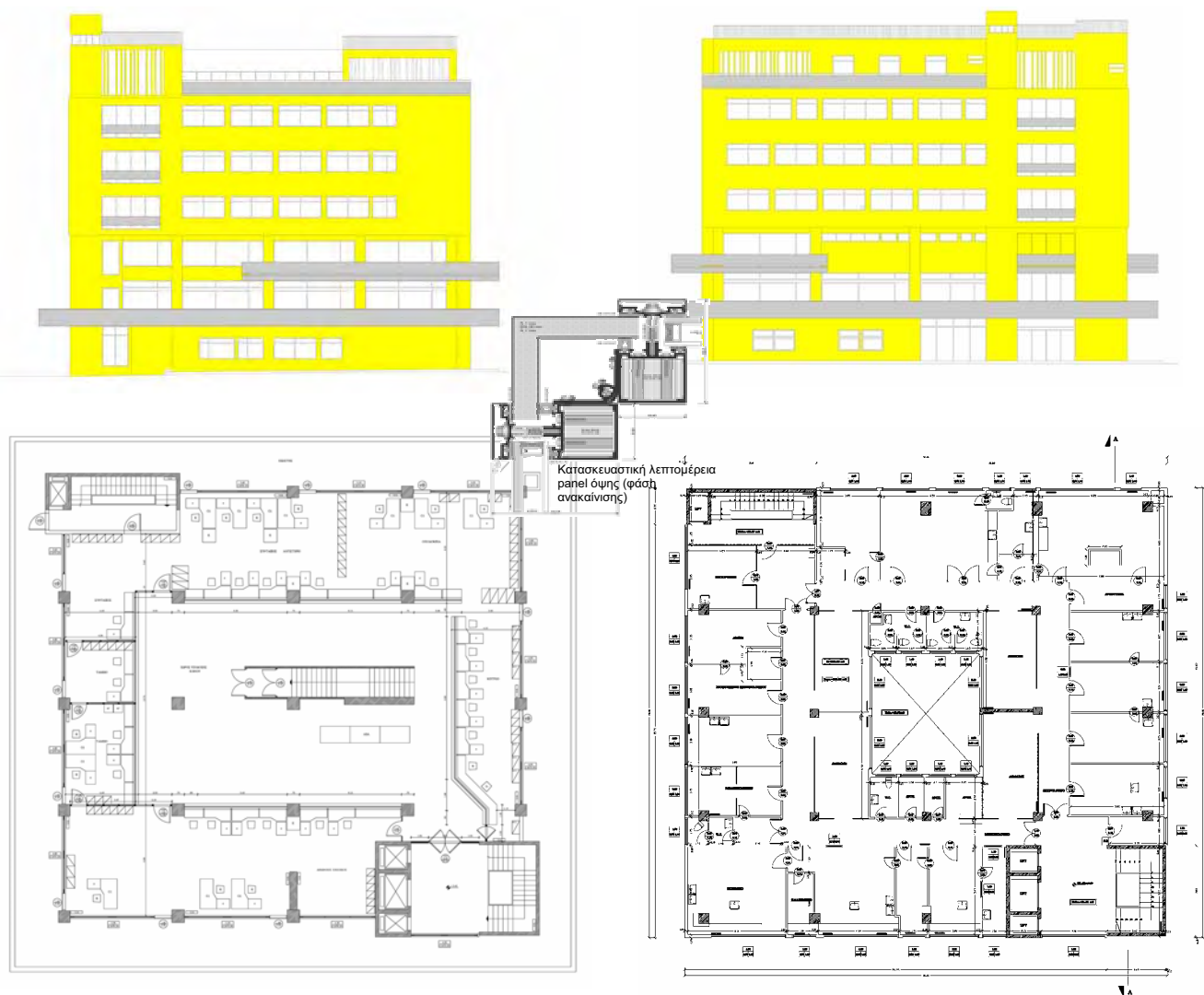
Σχ. 1. Το κτίριο γραφείων της Θεσσαλονίκης. Διαμόρφωση όψεων και κατόψεων και κατασκευαστική λεπτομέρεια πάνελ όψεων (φάση ανακαίνισης).
