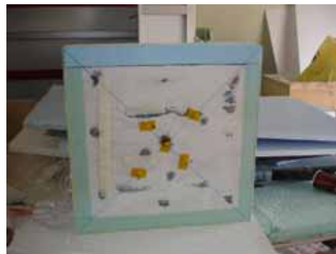
Εικόνα 6: Τελικό δοκίμιο με άδειες πλαστικές φιάλες νερού και περλίτη
