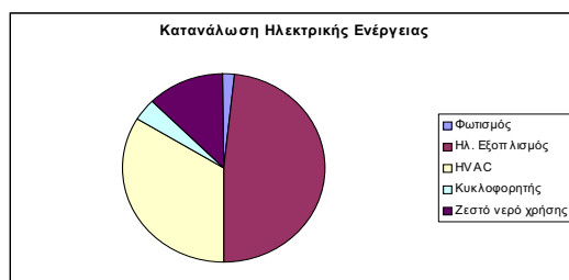
Εικόνα 5: Καταναλώσεις κτιρίου μετά την εγκατάσταση της αντλίας θερμότητας
