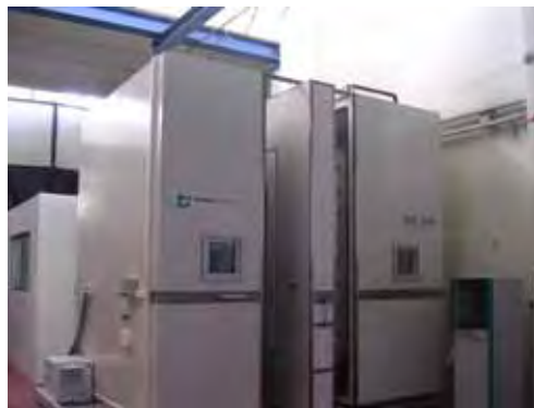
Σχήμα 1. Διάταξη προστατευμένου θερμού κιβωτίου
