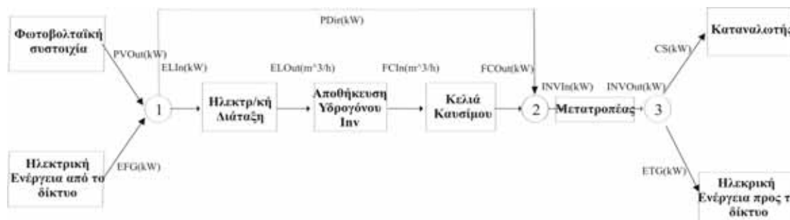
Διάγραμμα 1 Σχηματική διάταξη της υβριδικής μονάδας PV-FC
