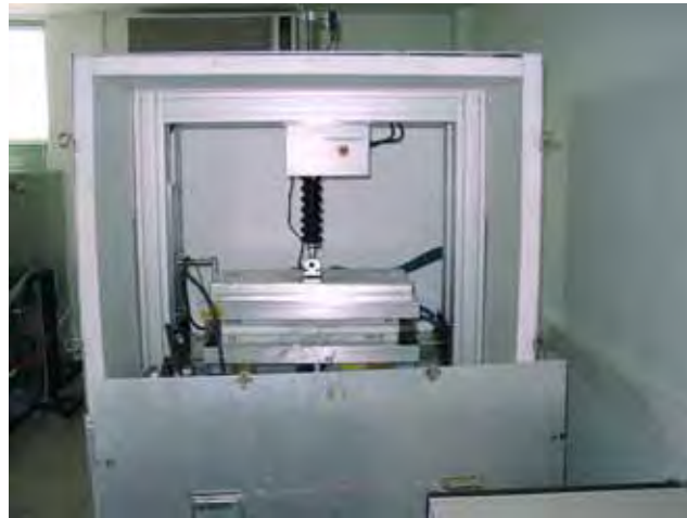
Εικόνα 1: Διάταξη Προστατευμένης Θερμής Πλάκας
