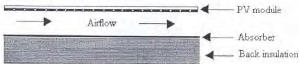
Σχήμα 1. Τυπικό σύστημα PV/T τύπου αέρα (PVT/AIR)
