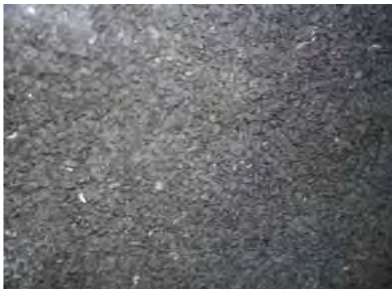
Εικόνα 7: Θρυμματισμένα ελαστικά (4x4x4mm)
