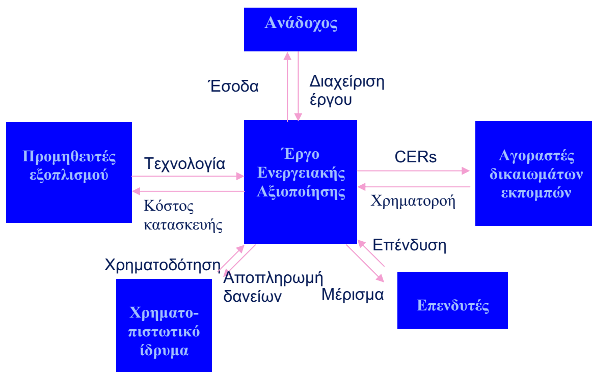
Σχήμα 2: Χρηματοδότηση έργου ενεργειακής αξιοποίησης βιομάζας και βιοαερίου μέσω του Clean Development Mechanism και της πώλησης δικαιωμάτων εκπομπής αέριων ρύπων.
