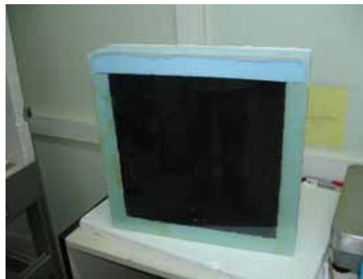
Εικόνα 8: Έτοιμο δοκίμιο με θρυμματισμένα ελαστικά
