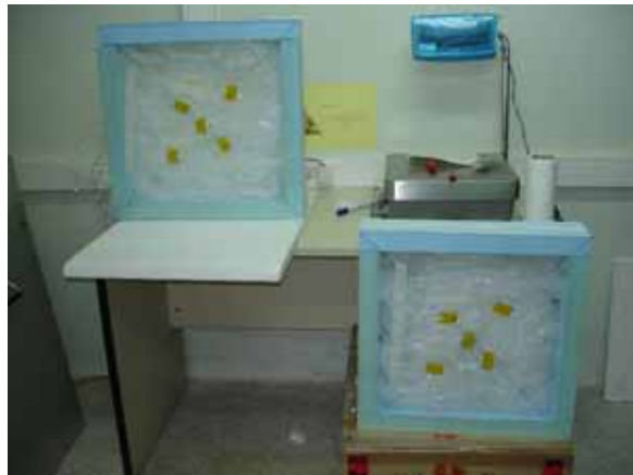
Εικόνα 4: Τα δύο δοκίμια με τα φύλλα περιτυλίγματος με φυσαλίδες
