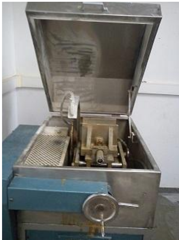
Εικόνα 6: Εργαστηριακό δισκοπρίνο κοπής δοκιμών πετρώματος.
