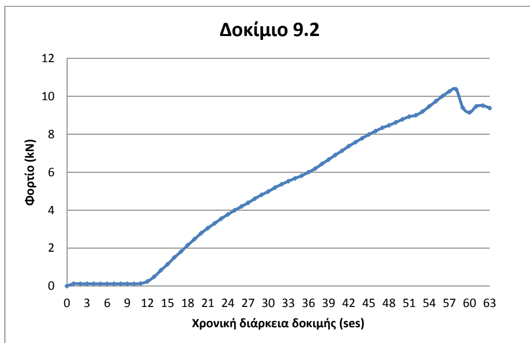
Σχήμα 4: Διάγραμμα φορτίου συναρτήσει της χρονικής διάρκειας της δοκιμής για το δοκίμιο 9.2.
