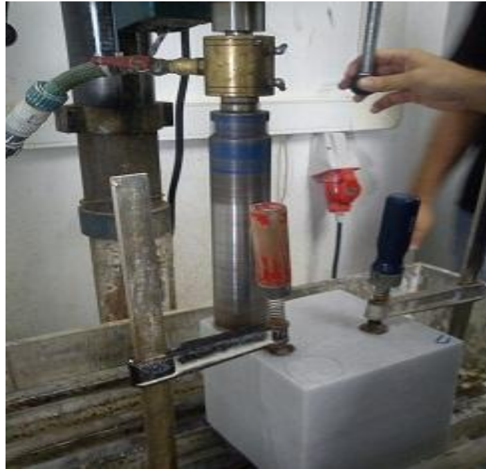
Εικόνα 5: Εργαστηριακό γεωτρύπανο (καροταρία).
