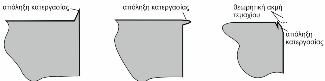
Σχήμα 2.4: Παραδείγματα χαρακτηριστικών απολήξεων σύμφωνα με τον Gillespie [1]
