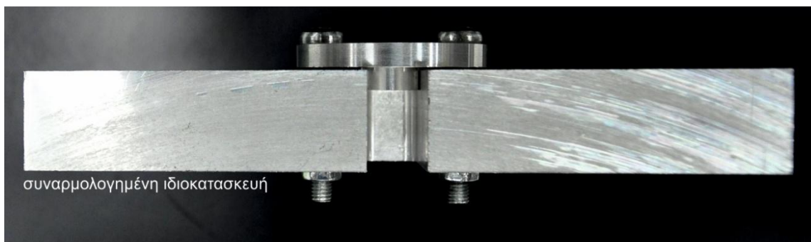
Σχήμα 4.18: Συναρμολόγηση ιδιοκατασκευής συγκράτησης των δοκιμών διάτρησης
