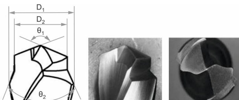
Σχήμα 2.17: Γεωμετρία κλιμακωτού εργαλείου διάτρησης (step drill), Ko et al. [9]
