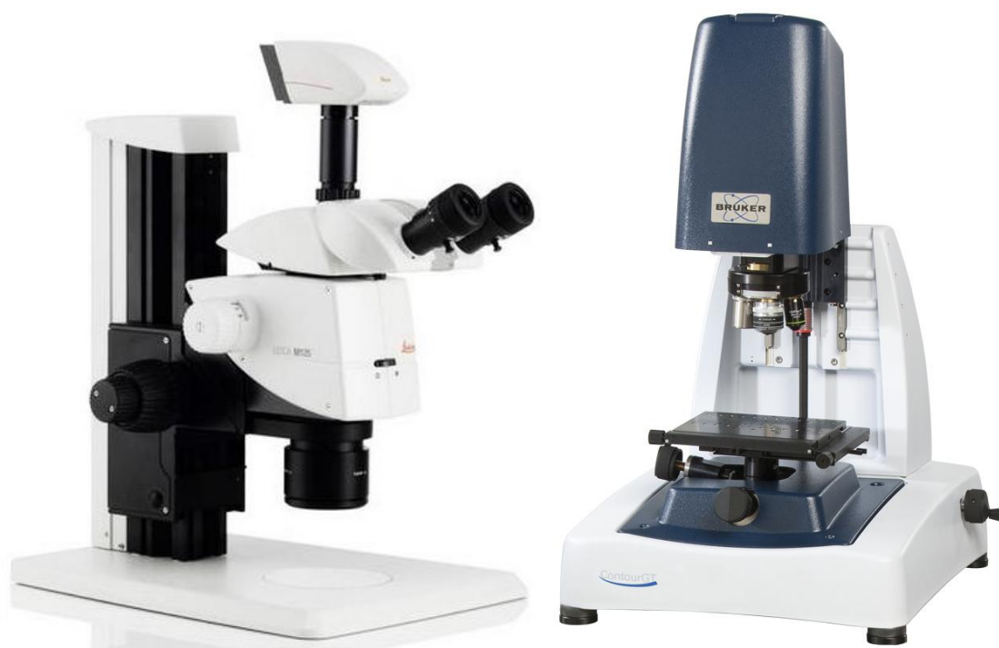
Σχήμα 5.1: Οπτικό Στερεομικροσκόπιο Leica M125 (αριστερά) και Οπτικό προφιλόμετρο Bruker ContourGT-K (δεξιά)
