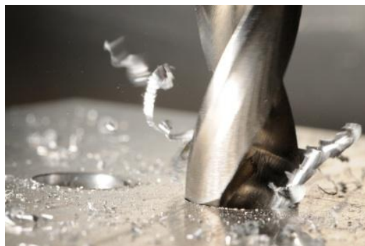
Σχήμα 2.1: Κατεργασία διάτρησης ή διάνοιξη οπών
