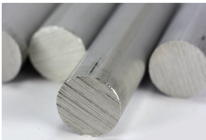
Σχήμα 4.4: Αρχικοί ακατέργαστοι κύλινδροι EN AW 2007
