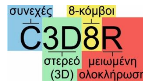
Σχήμα 3.9: Επεξήγηση κωδικής ονομασίας πεπερασμένων στοιχείων
