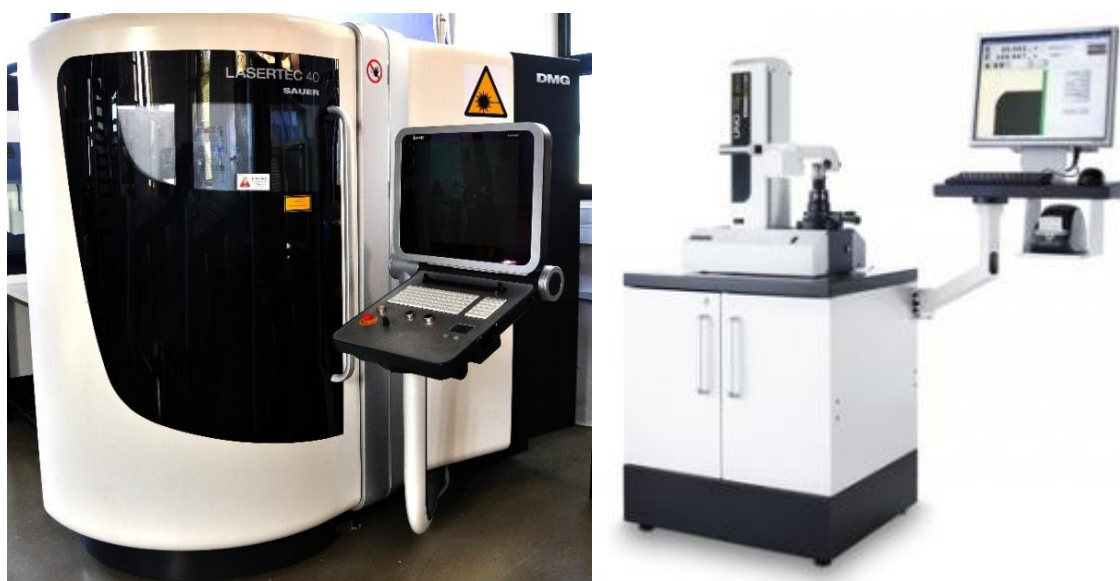
Σχήμα 4.2: Laser χάραξης Lasertec 40 (αριστερά) και συσκευή προρύθμισης εργαλείων Microset Uno 115 eco (δεξιά)
