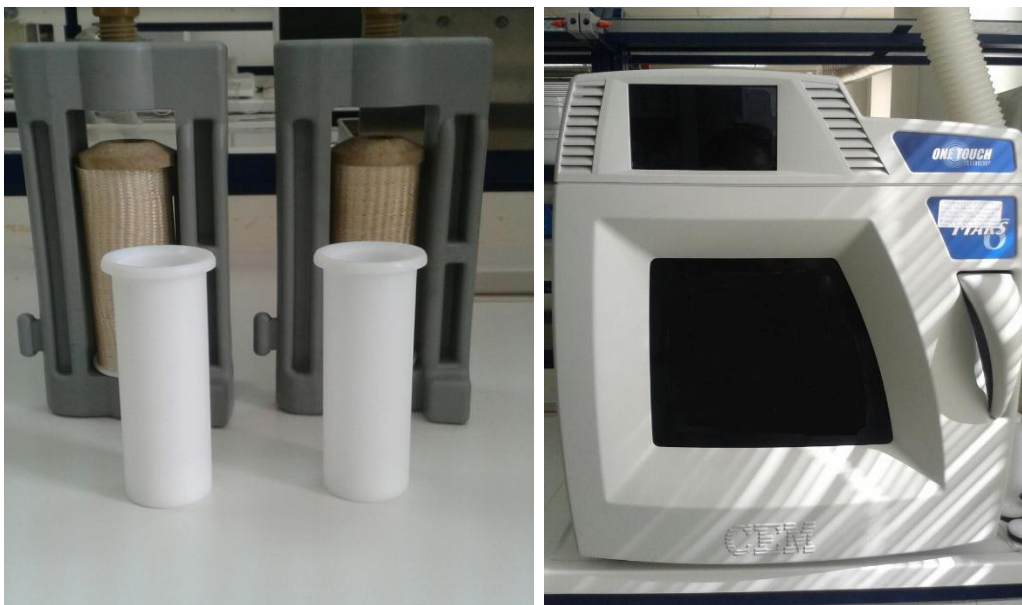
Εικόνα 3.7: Τα vessels και ο φούρνος ακτινοβολίας μικροκυμάτων Mars 6, που χρησιμοποιήθηκαν για τα πειράματα
