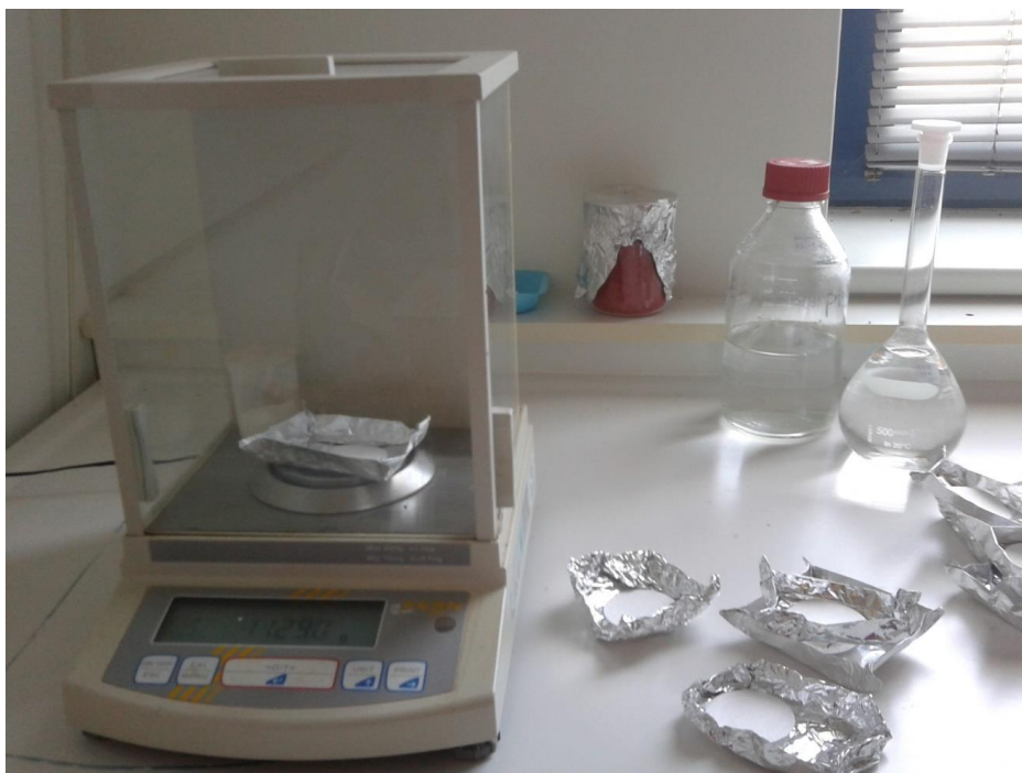
Εικόνα 4.2.2.1. Απεικόνιση ζυγίσματος φίλτρων για τον προσδιορισμό του TSS.
