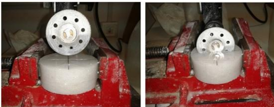
Σχήμα 4.5: Κατασκευή εγκοπής σε δοκίμια Βραζιλιάνικου δίσκου με την βοήθεια κοπτικού δίσκου.
