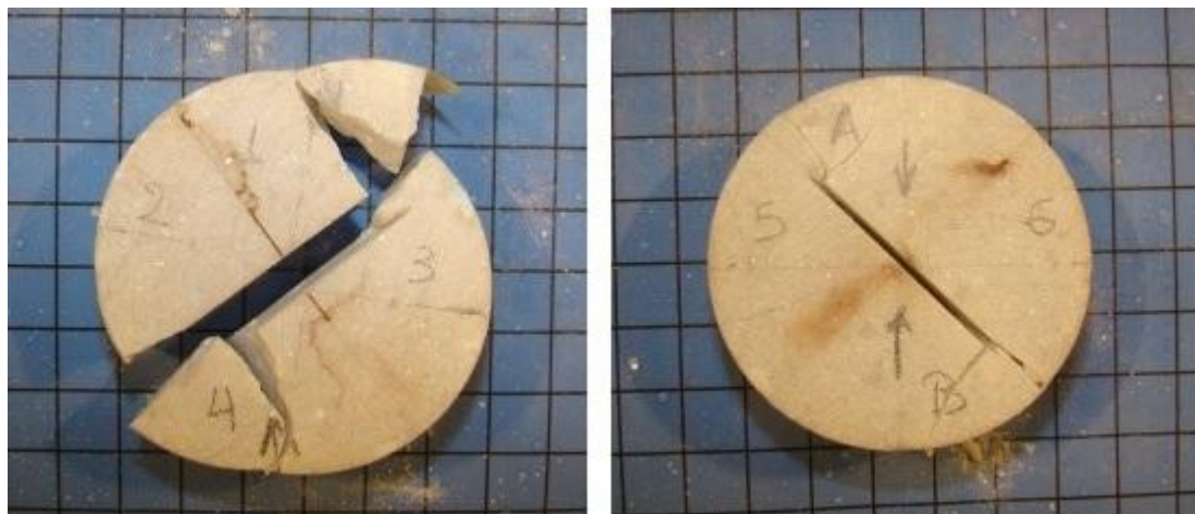
Σχήμα 5.10: Θραύση δοκιμίου 1.2 με την εγκοπή στις 45° από τον άξονα φόρτισης.
