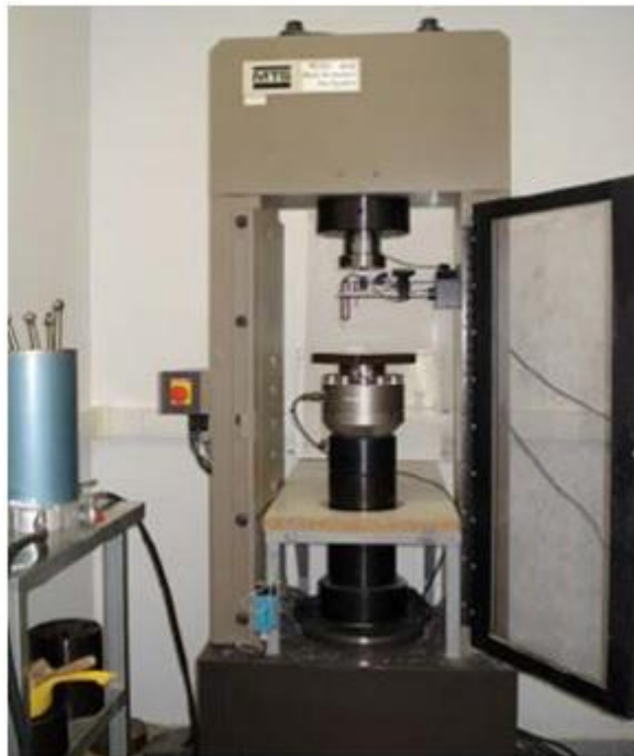
Σχήμα 4.6: Συσκευή φόρτισης MTS-815.
