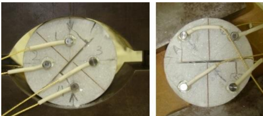
Σχήμα 5.9: Διάταξη αισθητήρων δοκιμίου 1.2 και προσανατολισμός εγκοπής σε σχέση με τον άξονα φόρτισης.
