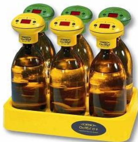
Εικόνα 3 : Σύστημα OxiTop για μέτρηση BOD 5
