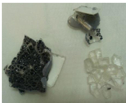
Εικόνα 23: Αποτελέσματα εφαρμογής γαλακτικού αιθυλεστέρα σε δείγμα mono(c-Si) πάνελ
