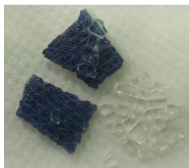
Εικόνα 22: Αποτελέσματα εφαρμογής γαλακτικού αιθυλεστέρα σε δείγμα poly(c-Si) πάνελ
