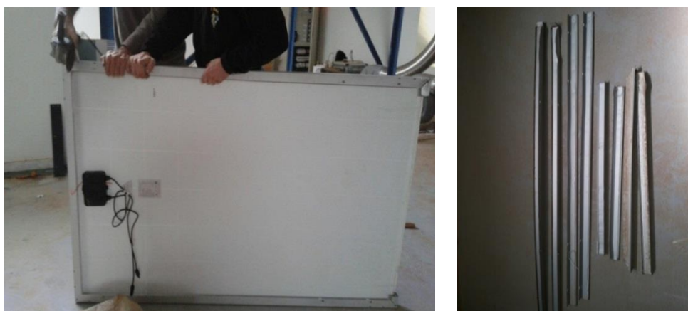
Εικόνα 7: Αποσυναρμολόγηση πλαισίου πολυκρυσταλλικού πυριτίου
