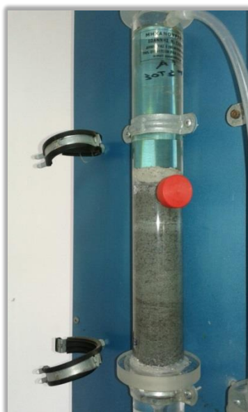
Εικόνα 15: Πειραματική διάταξη της δοκιμής εκπλυσιμότητας NEN 7343
