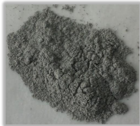
Εικόνα 24: Αποτελέσματα κοσκίνησης δείγματος \text{poly(c-Si)} πάνελ μετά την θερμική αποσύνθεση
