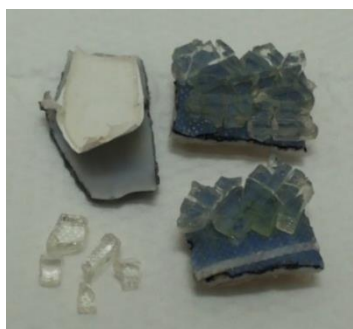
Εικόνα 22: Αποτελέσματα εφαρμογής γαλακτικού αιθυλεστέρα σε δείγμα poly(c-Si) πάνελ
