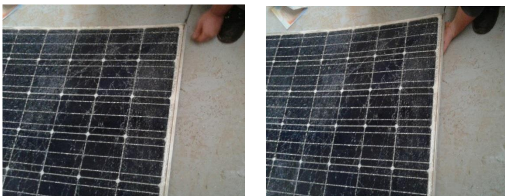
Εικόνα 6: Αποσυναρμολόγηση πλαισίου μονοκρυσταλλικού πυριτίου
