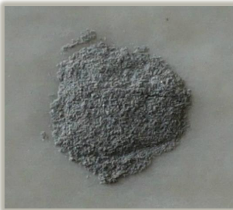
Εικόνα 25: Αποτελέσματα κοσκίνησης δείγματος \text{poly(c-Si)} πάνελ μετά την θερμική αποσύνθεση
