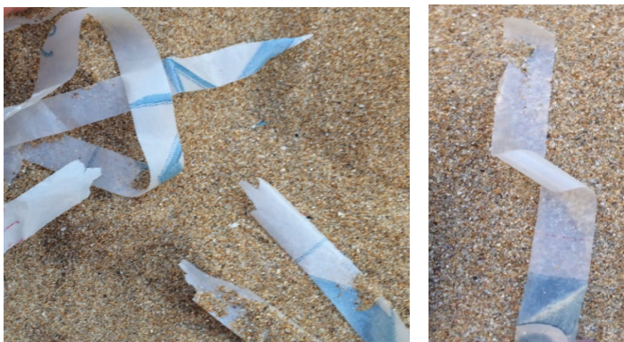
Φωτογραφία 2.24: πλαστικά γηρασμένα – φθαρμένα με ελλειπή κομμάτια στις άκρες τους.
