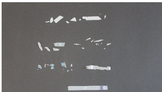
Φωτογραφία 3.5: Τοποθετημένα παράλληλα τα δείγματα της 9 ης δειγματοληψίας μαζί, μετά από 24 ώρες στην συσκευή θρυμματισμού
