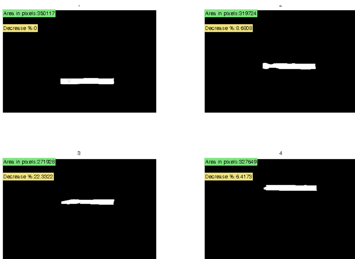
Φωτογραφία 3.4: Τοποθετημένα παράλληλα τα δείγματα της 9 ης δειγματοληψίας μαζί με την συνολική περιοχή σε pixels , η % μείωση στα ελλειπή κομμάτια των δειγμάτων σε σχέση με το αρχικό ολόκληρο, ύστερα από επεξεργασία εικόνας(processed image).
