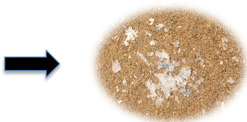
Φωτογραφία 3.7: Θρυμματισμένη σακούλα INKA, μετά από 6 μήνες.
