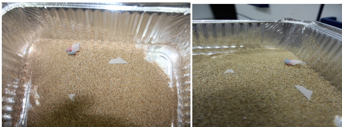
Φωτογραφία 2.29: θρυμματισμένα κομμάτια από την πλαστική σακούλα του χαλκιαδάκη μετά την διαδικασία της συσκευής θρυμματισμού.
