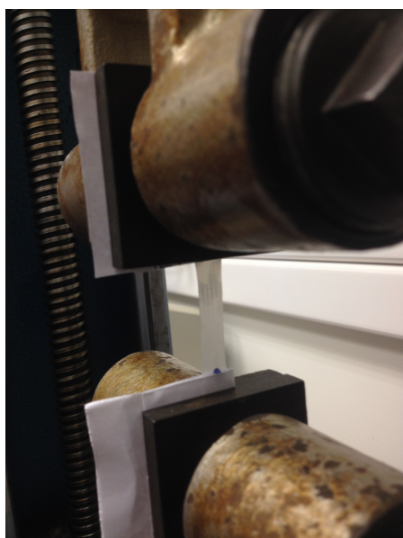
Φωτογραφία 2.14: μηχανήμα εφελκυσμού, INSTRON , πλαστικό δείγμα τυλιγμένο στο χαρτί
