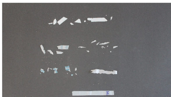
Φωτογραφία 2.30 : πλαστικά δείγματα τοποθετημένα πάνω στο μαύρο χαρτόνι, μετά την μία μέρα στην συσκευή ανάδευσης.
