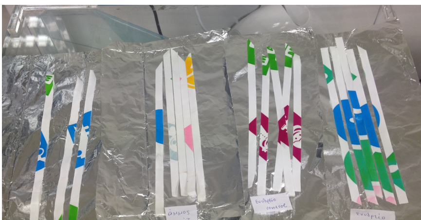
Φωτογραφία 2.2: πλαστική σακούλα jumbo κομμένη με λωρίδες
