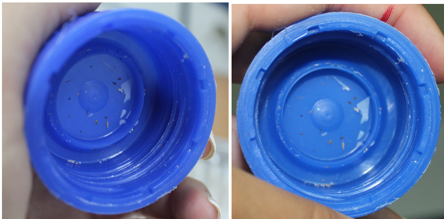
Φωτογραφία 2.31: προσκολλημένα θρύμματα από τα πλαστικά δείγματα πάνω στο καπάκι του δοχείου μετά από τη συσκευή θρυμματισμού.
