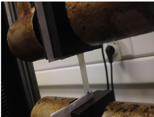
Φωτογραφία 2.15: μηχανήμα εφελκυσμού, instron, πλαστικό δείγμα βιοαποικοδομήσιμου αμύλου τυλιγμένο στο χαρτί
