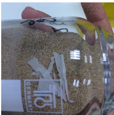
Φωτογραφία 2.28: πολυκαιρισμένο δείγμα, ύστερα από λίγες ώρες στο GFL, παρατηρήθηκε κάποιος μικρός θρυμματισμός.
