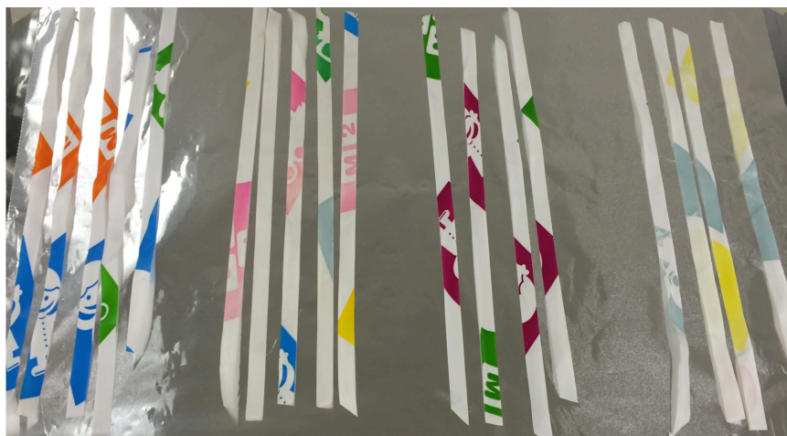
Φωτογραφία 3.11: Πλαστική σακούλα JUMBO 2 ου μήνα στα τέσσερα πειραματικά περιβάλλοντα.
