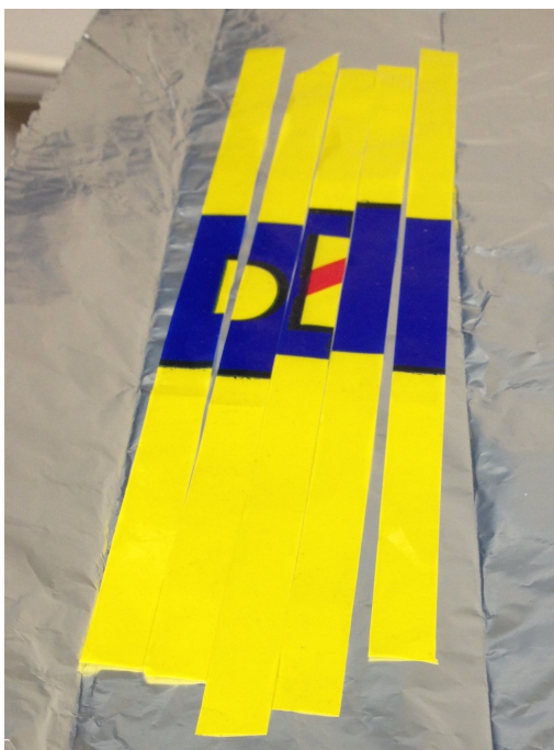
Φωτογραφία 2.1: πλαστική σακούλα LIDL κομμένη με λωρίδες
