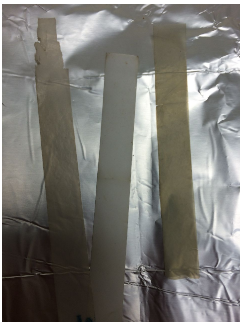
Φωτογραφία 2.20: γηρασμένες σακούλες εκτεθειμένες σε εξωτερικό περιβάλλον με έλλειψη κομματιών στις εκτεθειμένες άκρες.
