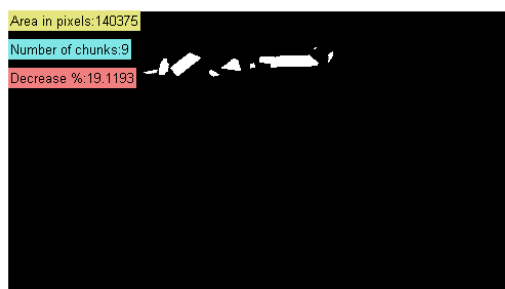
Φωτογραφία 3.6: Επεξεργασμένη εικόνα δειγμάτων πλαστικής σακούλας INKA μαζί με την συνολική περιοχή σε pixel, την % μείωση και τον αριθμό των θρυμματισμένων κομματιών μεγαλύτερα από 5mm, σε σχέση με το αρχικό, μετά από 24 ώρες στη συσκευή θρυμματισμού.
