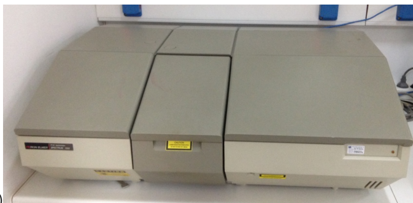
a) Φωτογραφία 2.17: α) μηχανήμα FT-IR, b) δέσμη της ακτινοβολίας που περνάει μέσα από το πλαστικό δείγμα, από ειδική θέση.
