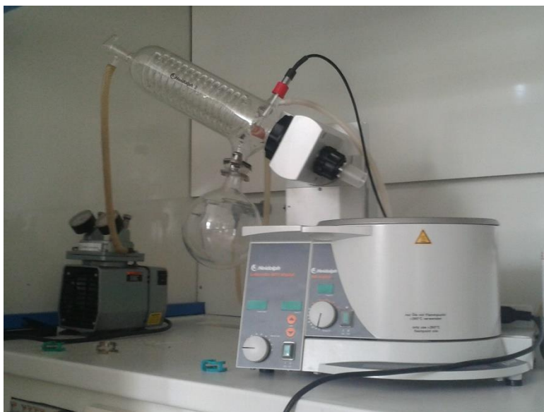
Εικόνα 13: Περιστροφικός εξατμιστήρας εργαστηρίου
