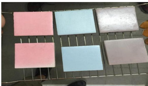
Εικόνα 23: Δείγματα με θερμοχρωμικό υλικό πριν θερμανθούν στο φούρνο.
