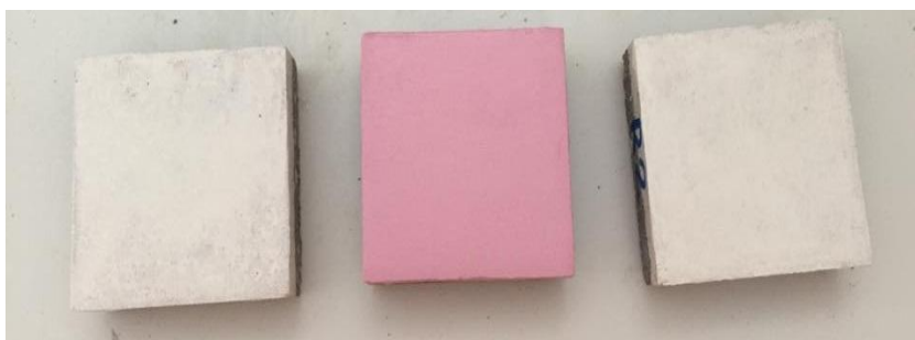
Εικόνα 25: Δείγματα με κόκκινο θερμοχρωμικό υλικό που έχουν θερμανθεί στον φούρνο σε σύγκριση με δείγμα καφέ συμβατικού χρώματος.
