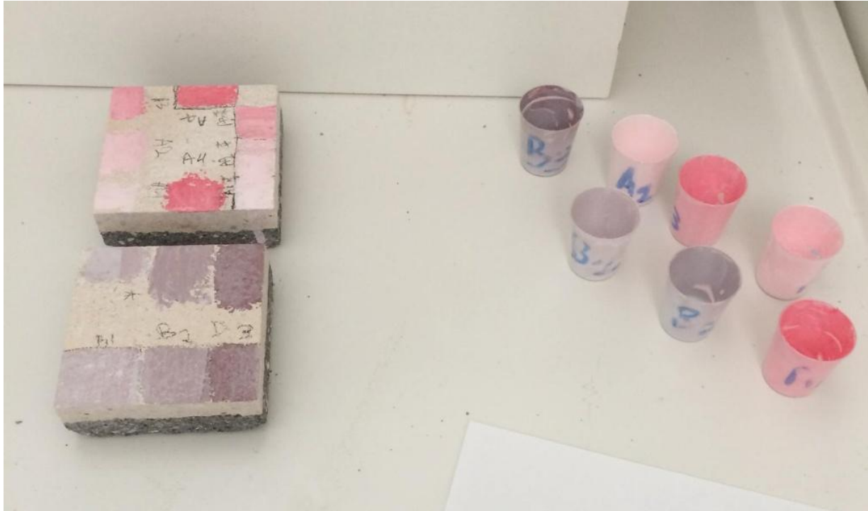
Εικόνα 2: Δοκιμές για την εύρεση της επί τοις εκατό % περιεκτικότητα θερμοχρωμικού υλικού.
