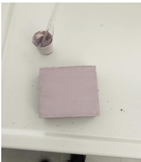
Εικόνα 8: Επίστρωση δοκίμιου με τελικό προϊόν.
