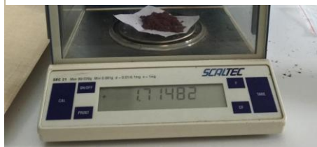
Εικόνα 6: Μέτρηση μάζας θερμοχρωμικού υλικού.
