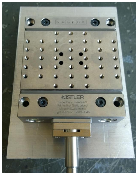
Σχήμα 3.9 Η βοηθητική πλάκα με τοποθετημένο πάνω της το δυναμόμετρο με χρήση κοχλίων
