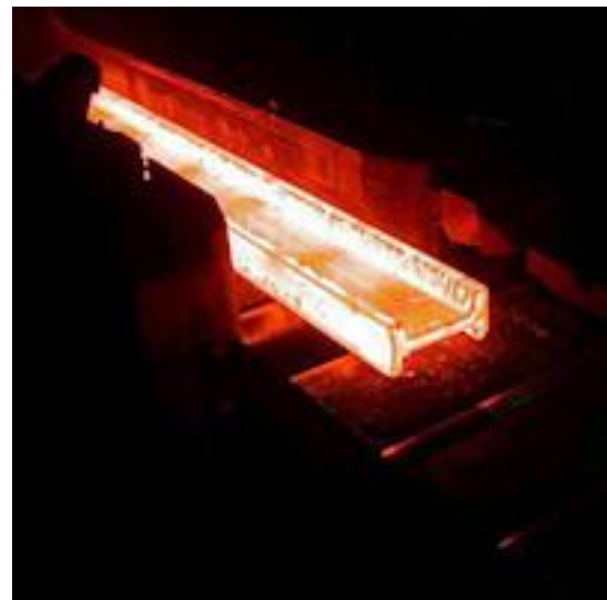
Εικόνα 28 Τελικό στάδιο θερμής έλασης διατομής I
