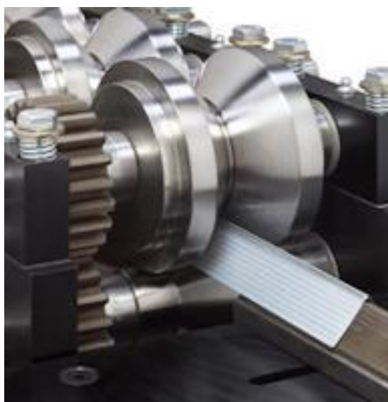
Εικόνα 34 Διαμόρφωση γωνιάς εν ψυχρώ
