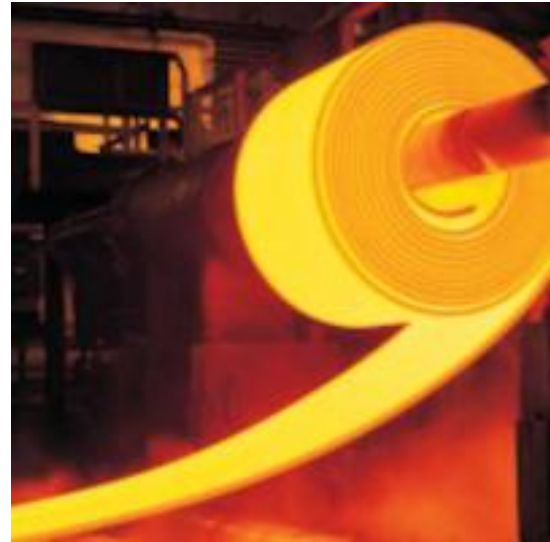
Εικόνα 27 Περιέλιξη Ελάσματος εν Θερμώ
