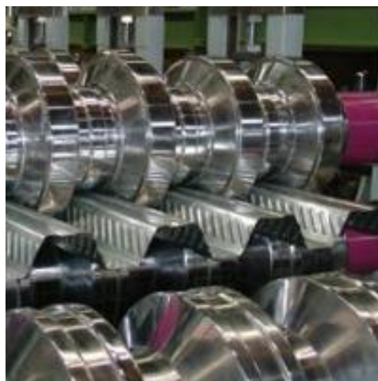
Εικόνα 31 Διαμόρφωση χαλυβδόφυλλων για σύμμικτες πλάκες
