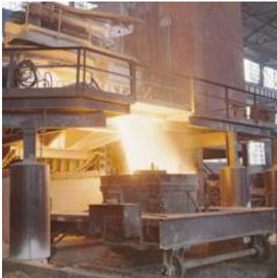
Εικόνα 26 Κλίβανος ηλεκτρικού τόξου
