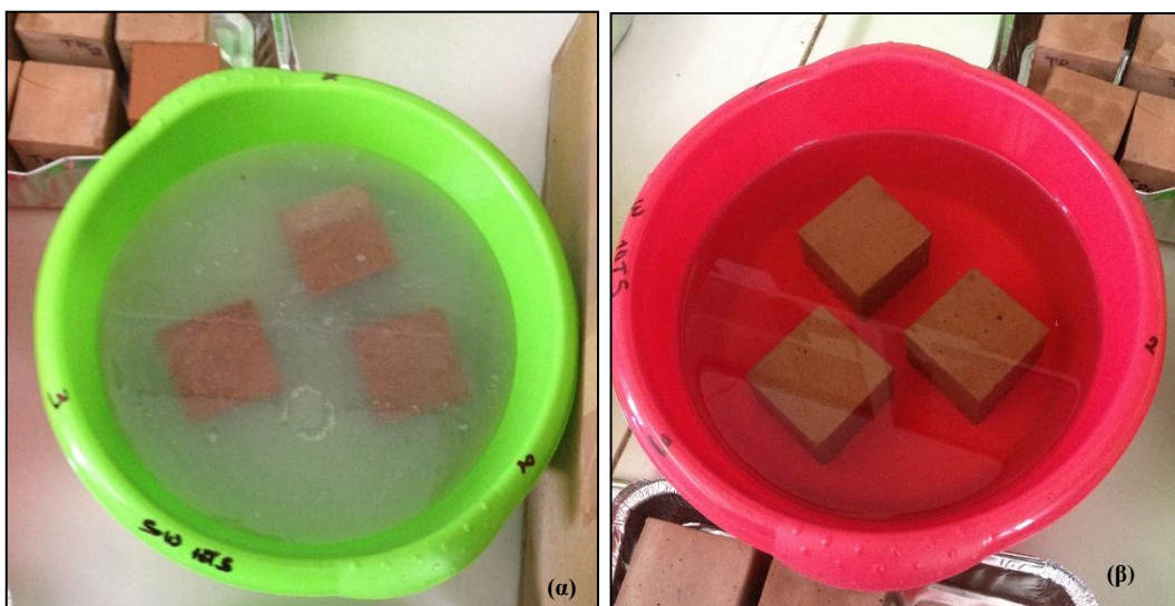
Σχήμα 3.7: Γεωπολυμερή από πλακάκια + 10% κ.β. ίζημα Σούδας εμβαπτισμένα σε (α) θαλασσινό και (β) απιονισμένο νερό
