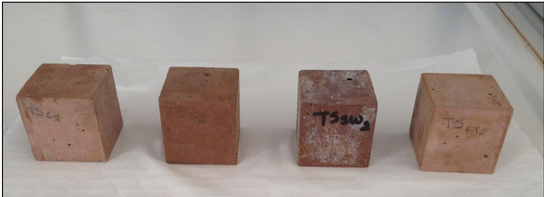
Σχήμα 3.10: Γεωπολυμερή από πλακάκια + 10% ίζημα Σούδας μετά το πέρας 2 μηνών σε δοκιμές ανθεκτικότητας. Αριστερά προς δεξιά: Γεωπολυμερές αναφοράς, εμφάπτιση σε απιονισμένο νερό, εμφάπτιση σε θαλασσινό νερό, δοκιμές σε κύκλους ψύξης – θέρμανσης
