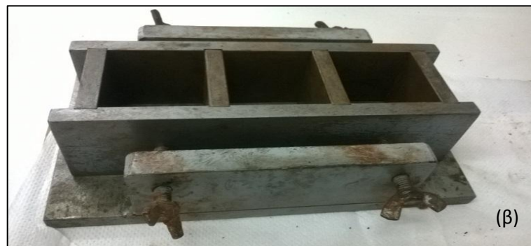
Σχήμα 3.3: (α) Μηχανική ανάδευση και (β) κυβικές μήτρες χύτευσης δοκιμίων
