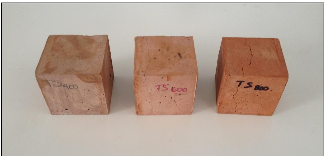
Σχήμα 3.11: Γεωπολυμερή από πλακάκια + 10% κ.β. ίζημα Σούδας, μετά την έγνηση σε 400, 600 και 800 °C με εμφανή τη χρωματική διαφοροποίηση
