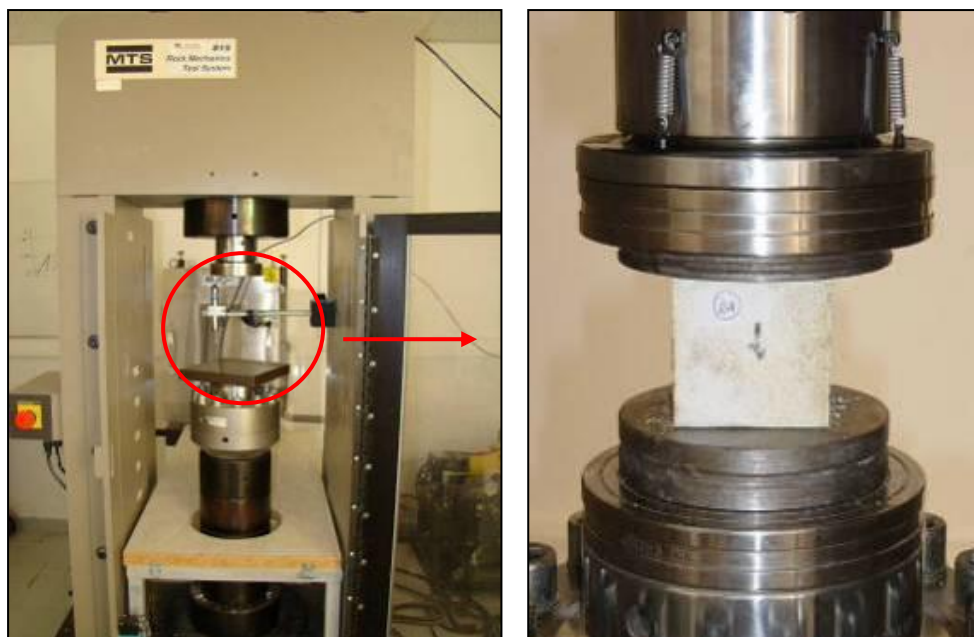
Σχήμα 3.5: Δοκίμιο σε φόρτιση σε μηχανή MTS
