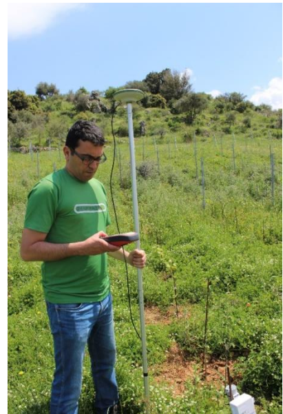
Εικόνα 27. Καταγραφή ακριβούς θέσης υγρασιόμετρου στην περιοχή μελέτης 3 με την χρήση GPS
