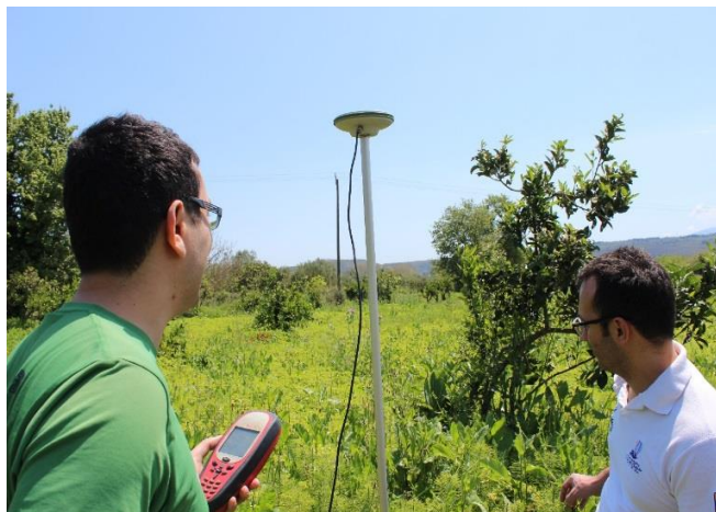
Εικόνα 22. Καταγραφή ακριβούς θέσης υγρασιόμετρου στην περιοχή μελέτης 2 με την χρήση GPS
