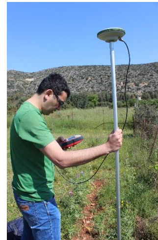
Εικόνα 20. Καταγραφή της ακριβούς θέσης υγρασιομέτρου περιοχής μελέτης 1 με την χρήση GPS υψηλής ακρίβειας.
