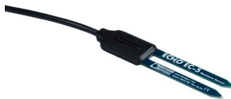
Εικόνα 28. Αισθητήρας Υγρασίας Εδάφους Decagon EC-5 (DECAGON, 2015)
