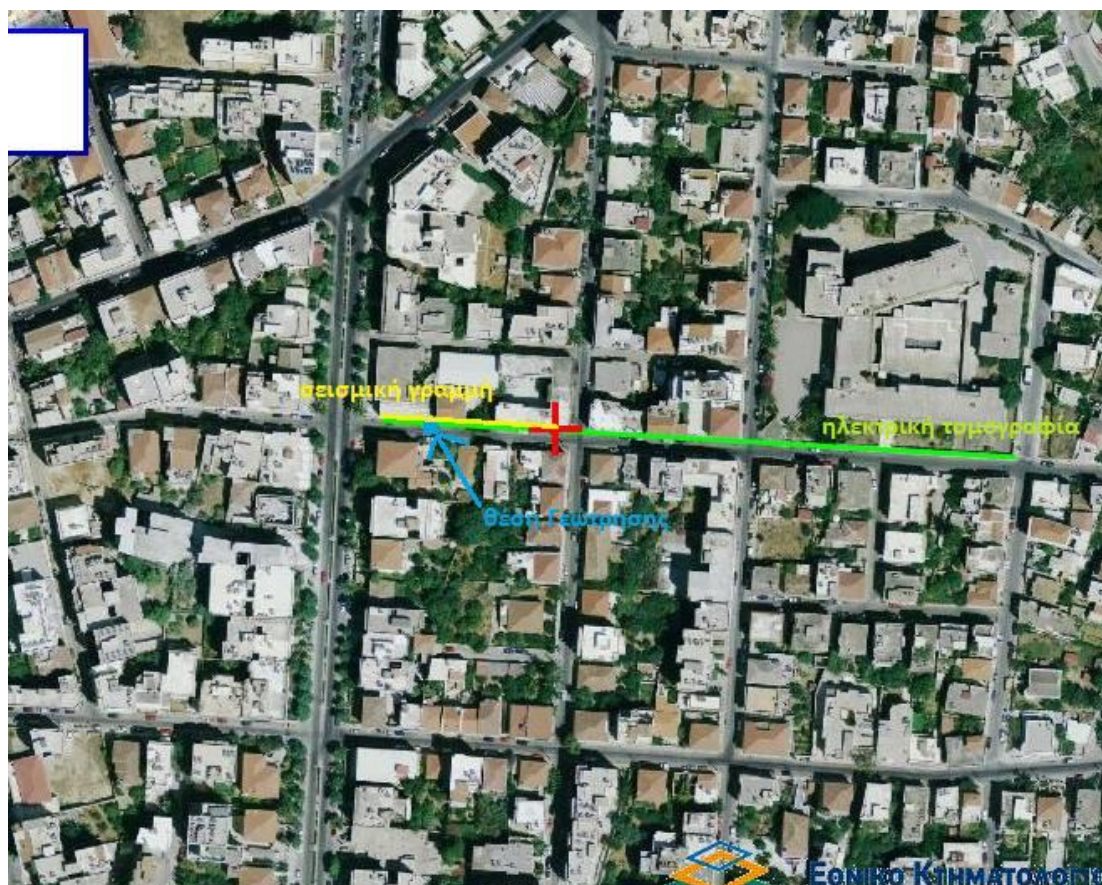
Σχήμα 3.1: Θέσεις των γραμμών μελέτης ηλεκτρικής τομογραφίας (πράσινη γραμμή), της σεισμικής διάθλασης (κίτρινη γραμμή) καθώς και της γεώτρησης (μπλέ σημείο) στην περιοχή των Χανίων.
