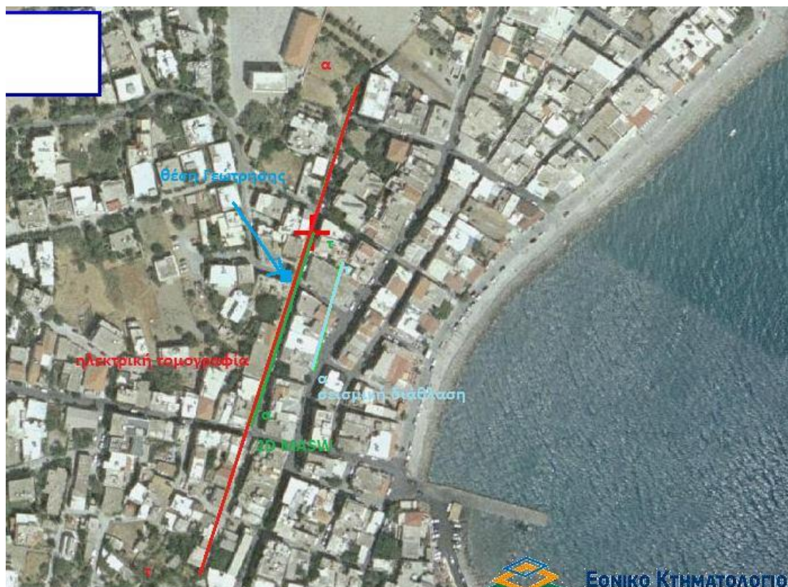
Σχήμα 3.2: Θέσεις των γραμμών μελέτης της ηλεκτρικής τομογραφίας (κόκκινη γραμμή), σεισμικής τομογραφίας (γαλάζια γραμμή-πάνω στην γραμμή), 2D MASW (πράσινη γραμμή) καθώς και της γεώτρησης (μπλέ σημείο) στην περιοχή της Παλαιόχωρας.
