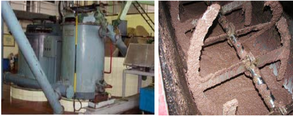
Εικόνα 2.5: Κυλινδρικός μαλακτήρας σε παραδοσιακό ελαιοτριβείο (αριστερά) και εσωτερικό μαλακτήρα στα σύγχρονα τριφασικά και διφασικά ελαιουργεία (δεξιά) (Κάλφας, 2007)
