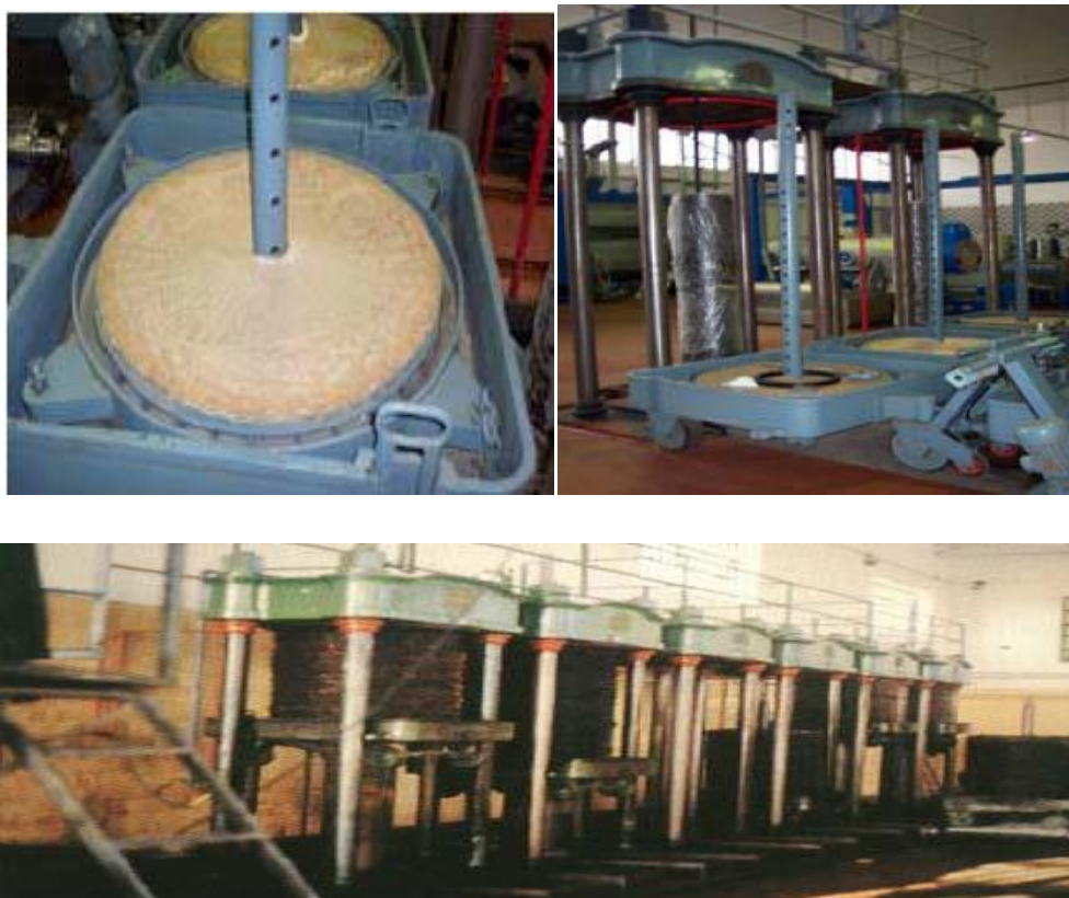
Εικόνα 2.6..: Εσωτερικός χώρος παραδοσιακού ελαιοτριβείου. Διακρίνονται οι διατάξεις πρέσας (κάτω και πάνω αριστερά) και τα ειδικά καροτσάκια (πάνω δεξιά) στα οποία τοποθετείται η ελαιοζύμη
