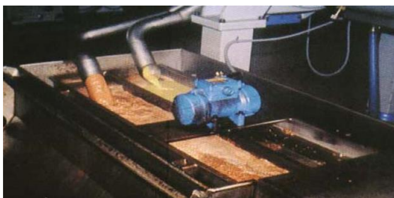
Εικόνα 2.12.: Κόσκινο απολάσπωσης στην έξοδο του διαχωριστήρα στα σύγχρονα ελαιοτριβεία (Κάλφας, 2007)
