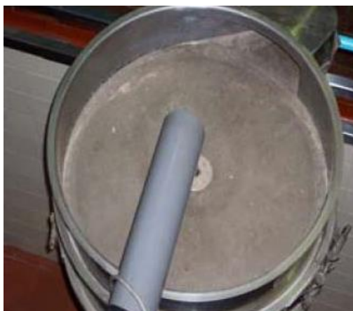
Εικόνα 2.11.: Κόσκινο απολάσπωσης σε παραδοσιακό ελαιοτριβείο (Κάλφας, 2007)
