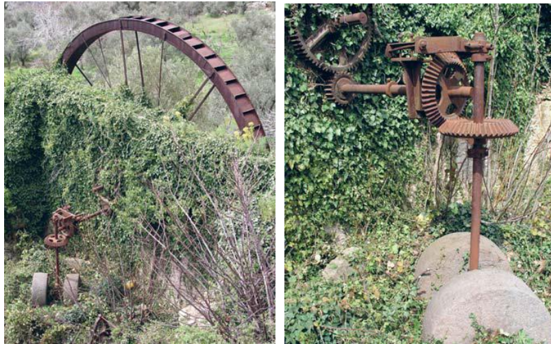
Εικόνες 4-5.: Ερείπια από υδροκίνητο ελαιοτριβείο, όπου φαίνεται η φτερωτή (αριστερά) και λεπτομέρεια του μηχανισμού που μετέτρεπε την κίνηση από τον οριζόντιο στον κάθετο άξονα (δεξιά)
