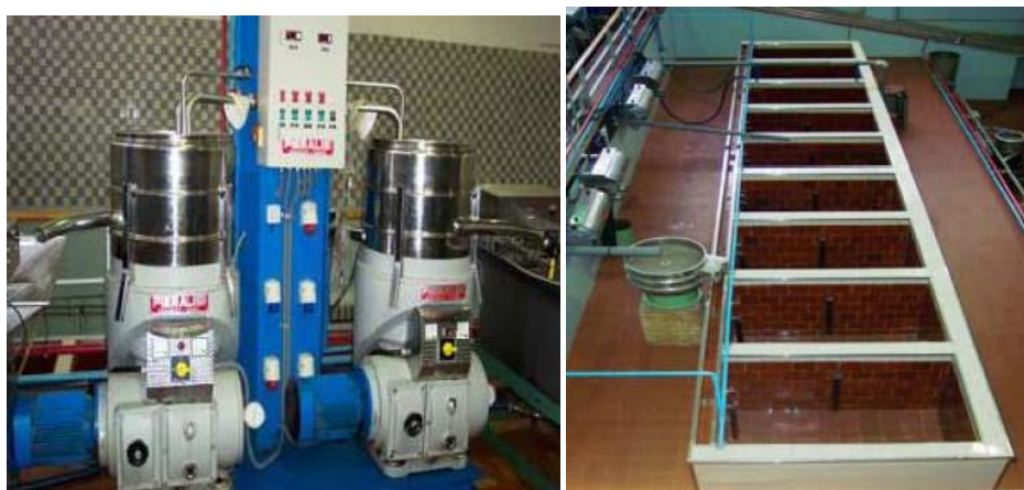
Εικόνα 2.13..: Αριστερά σύστημα φυγοκεντρικών διατάξεως στα σύγχρονα ελαιοτριβεία και δεξιά 9 δεξαμενές διαχωρισμού ελαιολάδου από το νερό στα παραδοσιακά ελαιοτριβεία
