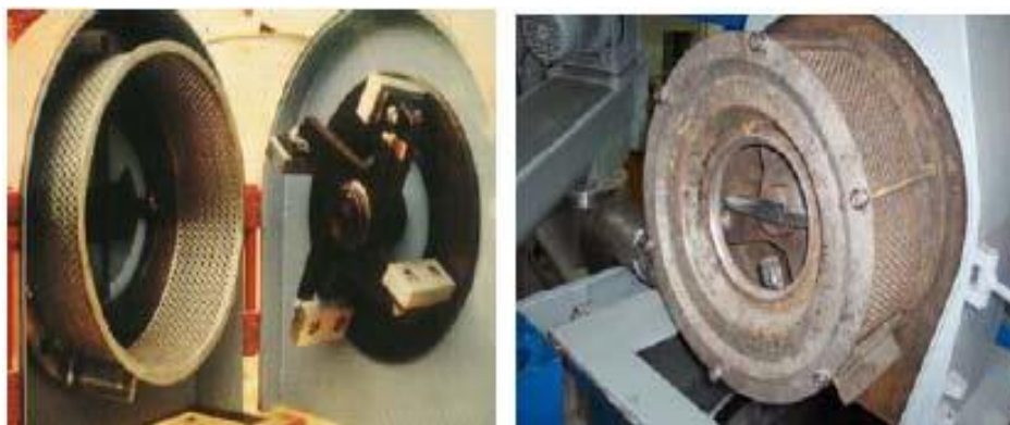
Εικόνα 2.4.: Διατάξεις που χρησιμοποιούνται για την σύνθλιψη του ελαιοκάρπου στα σύγχρονα τριφασικά και διφασικά ελαιουργεία
