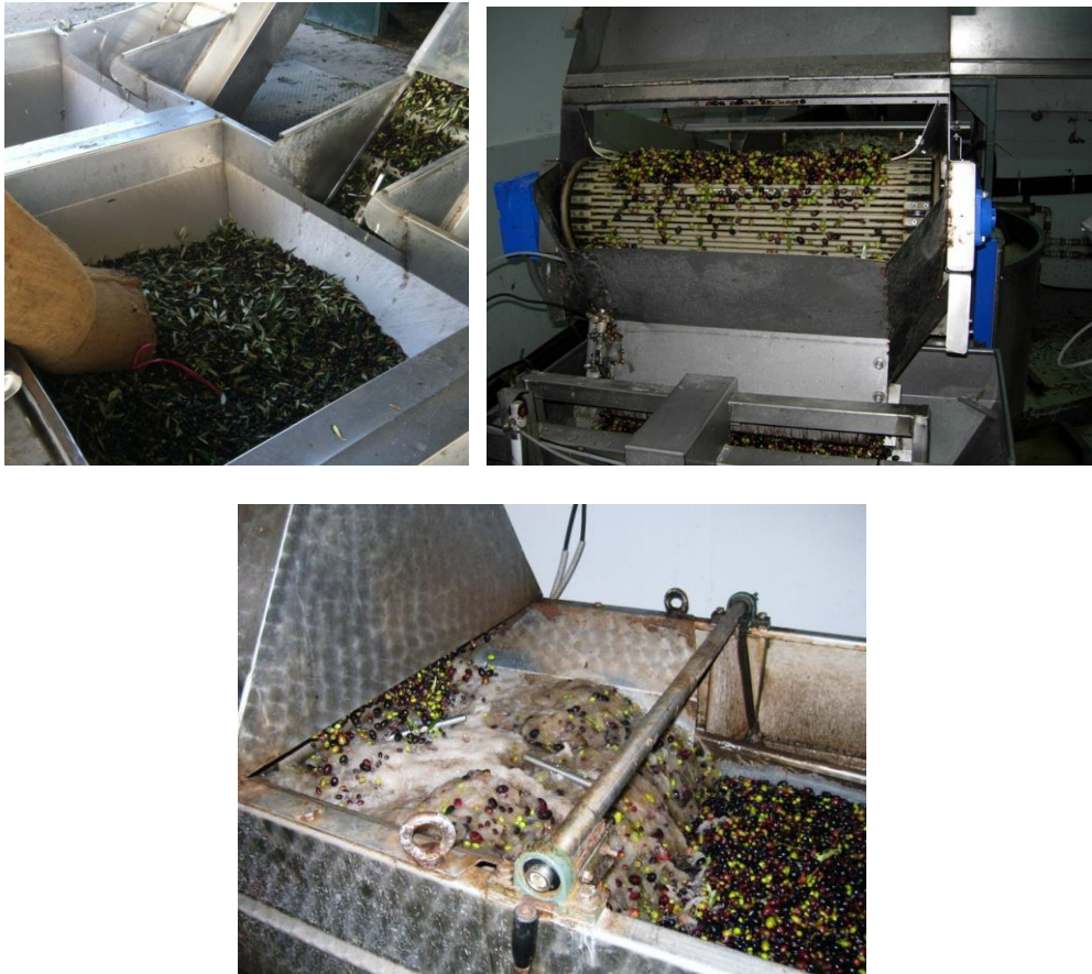
Εικόνα 2.2. (πάνω αριστερά): Χοάνη παραλαβής ελαιοκάρπου (πάνω δεξιά): Αποφυλλωτήριο ελαιοκάρπου (κάτω): Πλύσιμο ελαιοκάρπου
