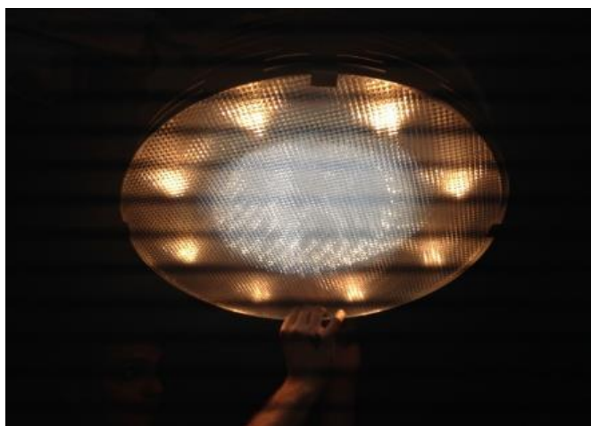
Εικόνα 34: Εσωτερικό τμήμα φωτοσωλήνα (διαχύτης) και λωρίδα LED.
