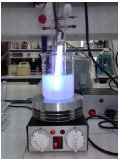
Εικόνα 7. Πειραματική διάταξη φωτοκατάλυσης με ακτινοβολία UVA
