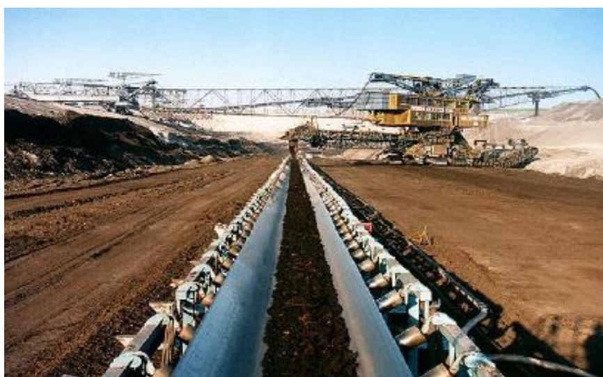
Εικόνα 2.8: Εξόρυξη του λιγνίτη σε βαθμίδα και μεταφορά του με ταινιόδρομο [4].
