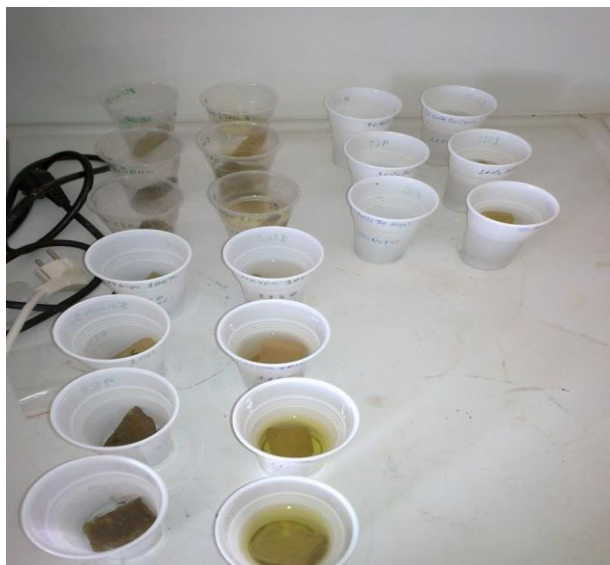
Εικόνα 3.11. Δοκίμια εμβαπτισμένα σε νερό και σε γαστρικό οξύ
