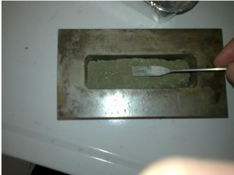
Εικόνα 3.3. Τοποθέτηση του υλικού στη μήτρα
