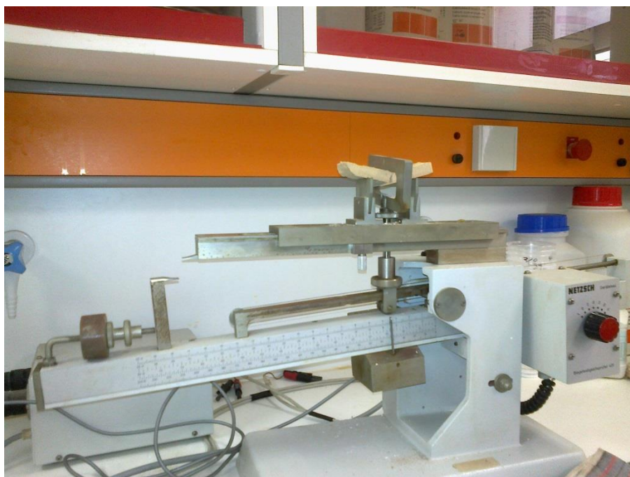
Εικόνα 3.9. Συσκευή Κάμψης
