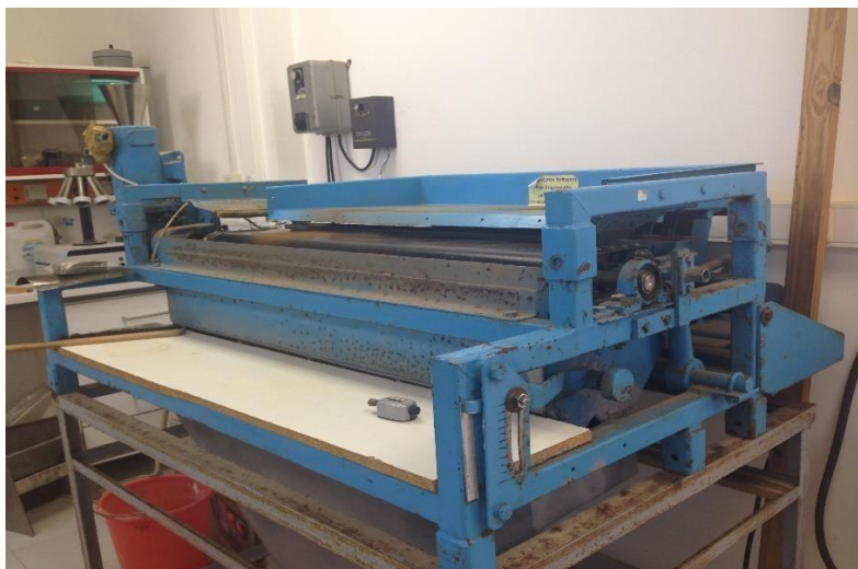
Εικόνα 8.9: Ο ταινιοφόρος μαγνητικός διαχωριστής (PermRoll).
