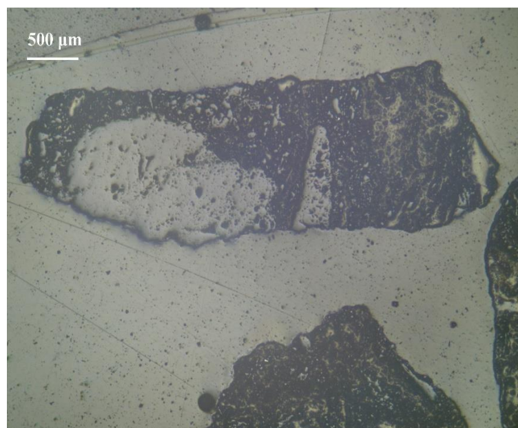
Εικόνα 8.2: Κόκκοι συνδετικού υλικού με μη αποδεσμευμένους κόκκους χαλαζία. Δείγμα B1, sink (-8 +4 mm). Ανακλώμενο φως, //Nicols.
