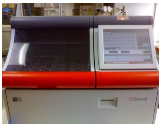
Εικόνα 4.3: Φασματοσκόπιο ακτίνων-X φθορισμού του Εργαστηρίου Ανόργανης Γεωχημείας, Οργανικής Γεωχημείας και Οργανικής Πετρογραφίας του Πολυτεχνείου Κρήτης.
