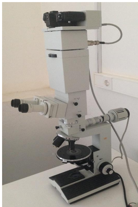
Εικόνα 4.1: Μικροσκόπιο ανακλώμενου και διερχόμενου φωτός του Εργαστηρίου Γενικής και Τεχνικής Ορυκτολογίας του Πολυτεχνείου Κρήτης.
