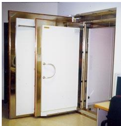
Σχήμα 3.6 Η είσοδος ενός MSR, με τα ξεχωριστά επίπεδα θωράκισης.
