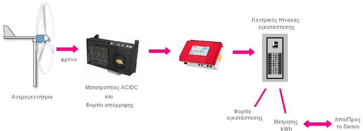
Απλοποιημένο διάγραμμα διασυνδεδεμένου συστήματος με Α/Γ μικρής ισχύος χωρίς μπαταρίες [54]
