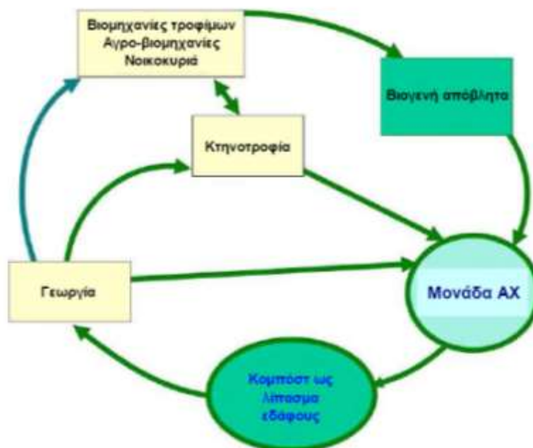
Εικόνα 3.10: Σχηματική αναπαράσταση του κλειστού κύκλου της συγκεντρωμένης αναερόβιας χώνευσης (Al Seadi et al., 2001)
