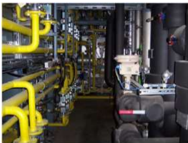
Εικόνα 4.6: Εγκατάσταση συστήματος PSA μονάδας βιομεθανίου στο Pliening της Γερμανίας (Rutz et al. 2008)
