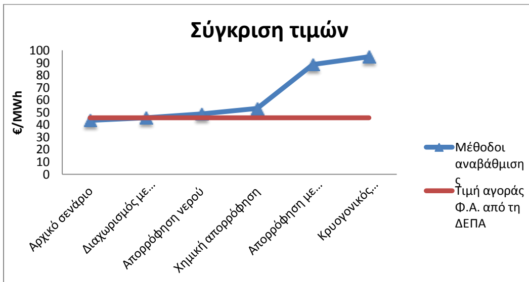
Εικόνα 7.10: Σύγκριση επιθυμητής τελικής τιμής αναβάθμισης βιοαερίου σε βιομεθάνιο με την τιμή προμήθειας της ΕΠΑ από τη ΔΕΠΑ, αναλόγως με τη χρησιμοποιούμενη μέθοδο αναβάθμισης
