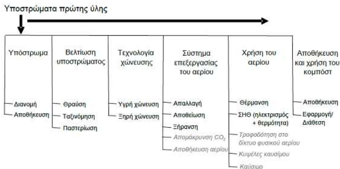
Εικόνα 3.5: Κύρια βήματα διεργασίας παραγωγής βιοαερίου (Σιούλας Κ. ΚΑΠΕ)
