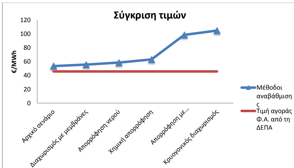
Εικόνα 7.11: Σύγκριση επιθυμητής τελικής τιμής αναβάθμισης βιοαερίου σε βιομεθάνιο με την τιμή προμήθειας της ΕΠΑ από τη ΔΕΠΑ, αναλόγως με τη χρησιμοποιούμενη μέθοδο αναβάθμισης
