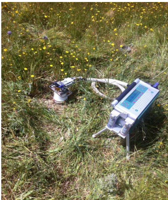
Εικόνα 2.3 Συσκευή μέτρησης ροής \text{CO}_2 LI-COR 6400 και θάλαμος μέτρησης (6400-09 Soil \text{CO}_2 Flux Chamber), στην εδαφική μεταχείριση C.
