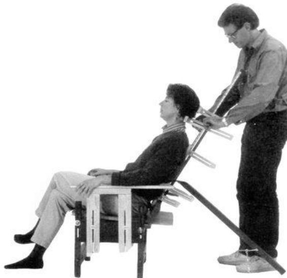
Ρυθμιζόμενη κατασκευή για την εύρεση των σωστών, εργονομικά, διαστάσεων καρέκλας από τους John και Caroline Grew-Sheridan.
