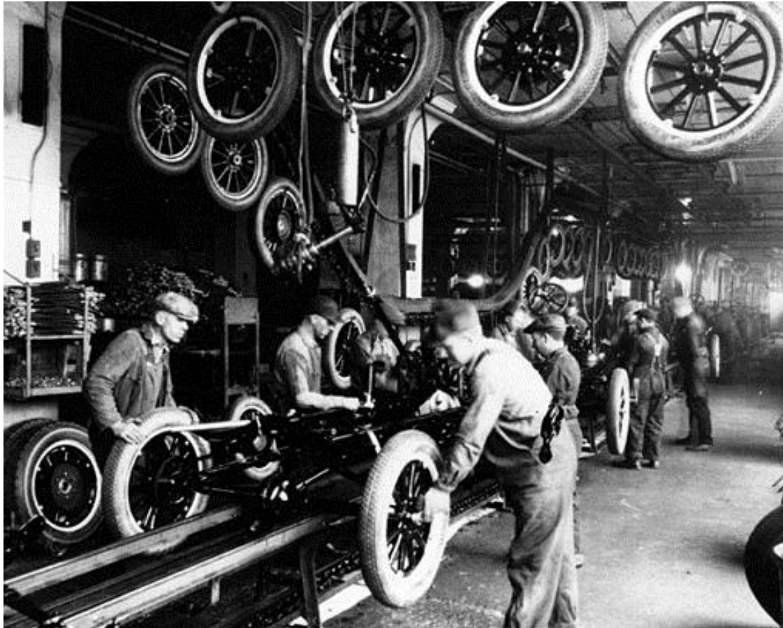
Κινούμενη γραμμή συναρμολόγησης του μοντέλου T της αυτοκινητοβιομηχανίας Ford το 1913
