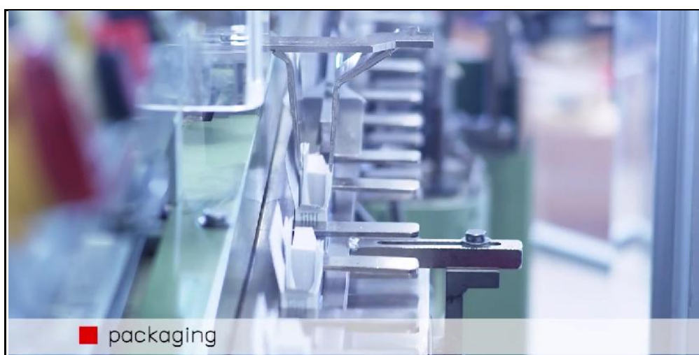
Εικόνα 4.18: Συσκευασία σε κουτιά, άνοιγμα κουτιών στη μηχανή συσκευασίας
