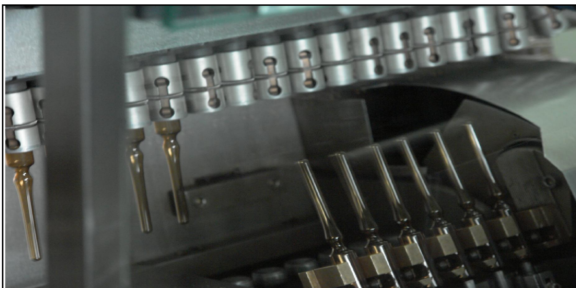
Εικόνα 4.9:Είσοδος φυσιγγων στην μηχανή και αναστροφή αυτών
