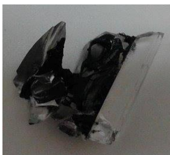
Εικόνα 19: Παραμόρφωση του δείγματος CIS με την προσθήκη τολουολίου
