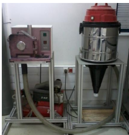
Εικόνα 8:Συσκευή ομογενοποίησης puluerisette 19 FRITCH και κυκλώνας Nabertherm
