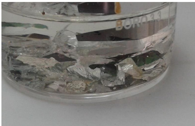
Εικόνα 21: Διαχωρισμός «ασημί επίστρωσης» με την προσθήκη \text{HCl} στο φ/β a-Si της Sharp
