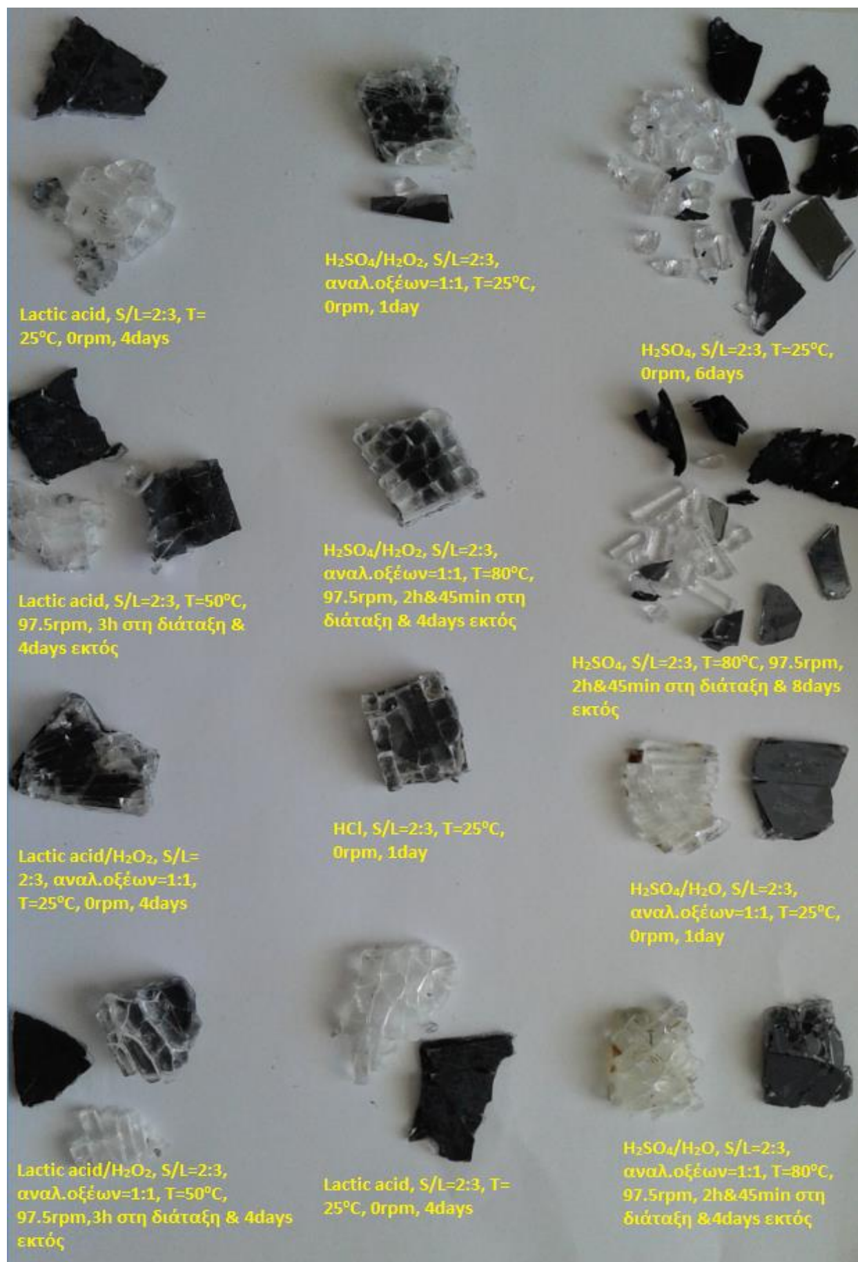
Εικόνα 26: Αποτελέσματα δοκιμών προσθήκης \text{H}_2\text{SO}_4 , \text{H}_2\text{SO}_4/\text{H}_2\text{O} , \text{H}_2\text{SO}_4/\text{H}_2\text{O}_2 , \text{HCl} , Lactic acid και Lactic acid/ \text{H}_2\text{O}_2 στο φ/β CIS της Solar Frontier K.K.
