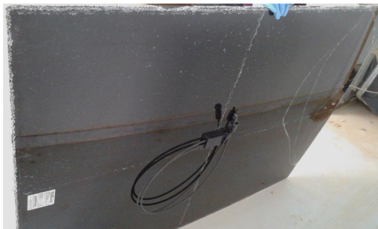
Εικόνα 3: Φωτοβολταϊκό a-Si:H/μc-Si:H της εταιρείας Sharp (α) μπροστινή επιφάνεια και (b) πίσω επιφάνεια
