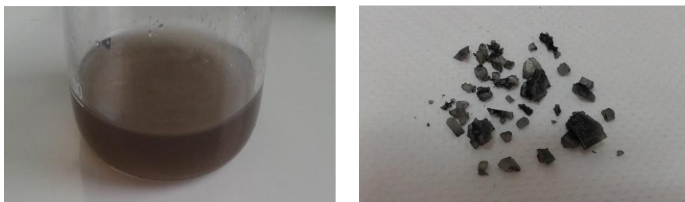
Εικόνα 17: Χρωματισμός του δείγματος και του διαλύματος toluene σε δείγματα φ/β a-Si της Sharp
