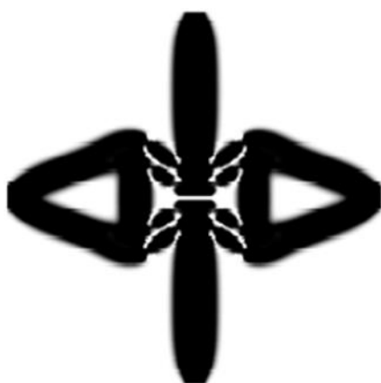
Εικόνα 4. Η ετερογενής κατανομή υλικού που προέκυψε από την τοπολογική βελτιστοποίηση. Παρουσία μόνο του hard material . [1]
