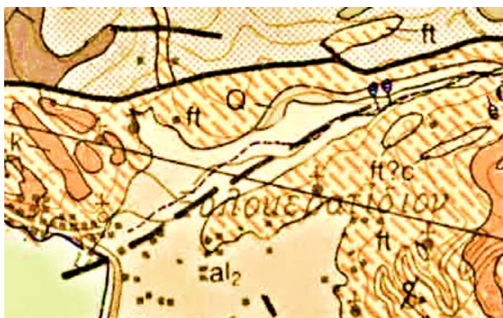
Εικόνα 4.17 Γεωλογικός χάρτης του Βόρειου τμήματος της περιοχής μελέτης. Q: χαλίκια – κροκαλοπαγή και ογκόλιθοι, al2: αλλουβιακές αποθέσεις
