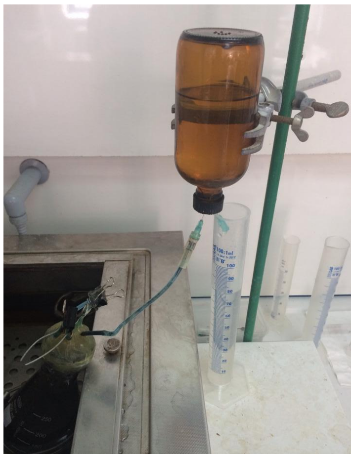
Εικόνα 4- Βύθιση αντιδραστήρων σε υδατόλουτρο και ογκομέτρηση μεθανίου με διάλυμα KOH
