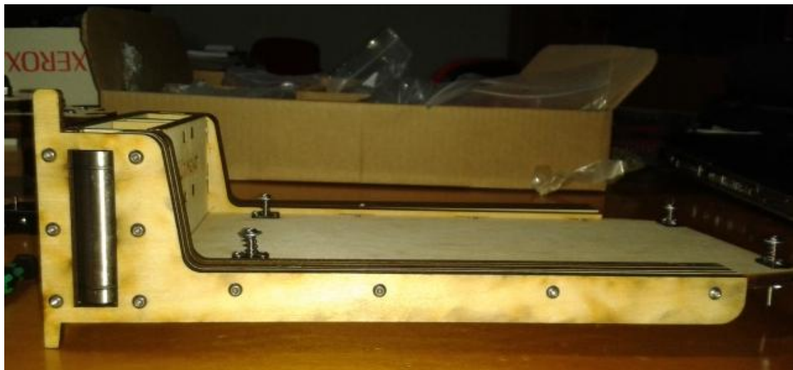
Εικόνα 51 Συναρμολόγηση τραπέζιου εκτύπωσης, άξονας z.
