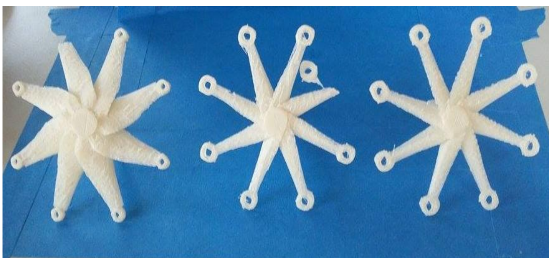
Εικόνα 74 Προσπάθειες αλλαγής του πάχους των πτερυγίων. Δεξιά φαίνεται το τελικό αποτέλεσμα.
