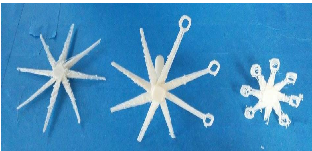
Εικόνα 73 Αριστερά βλέπουμε το αρχικό σχέδιο στο οποίο ο εκτυπωτής δεν μπορούσε να εκτυπώσει τους κύκλους στην άκρη των πτερυγίων. Τα άλλα δύο αντικείμενα αποτελούν προσπάθειες αλλαγής στη γεωμετρία που δεν πέτυχαν.
