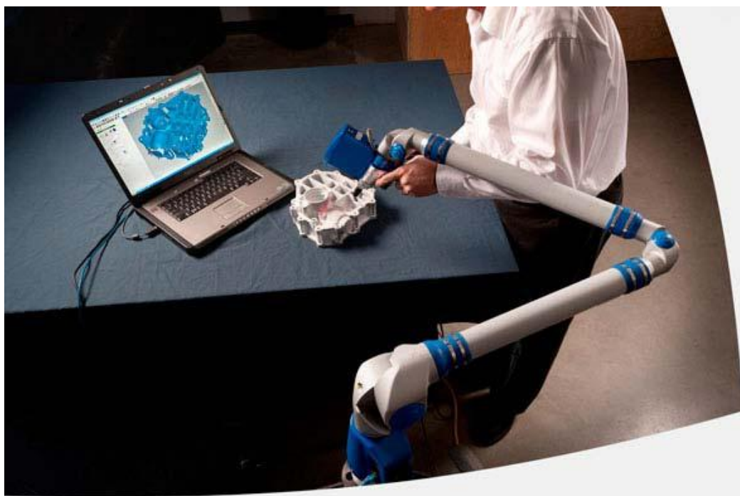
Εικόνα 24 (β) Ρομποτικός βραχίονας με laser.
