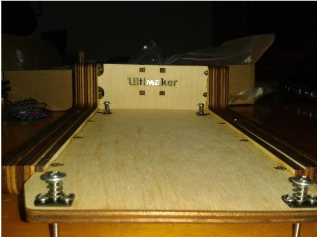
Εικόνα 50 Συναρμολόγηση τραπέζιου εκτύπωσης, άξονας z.
