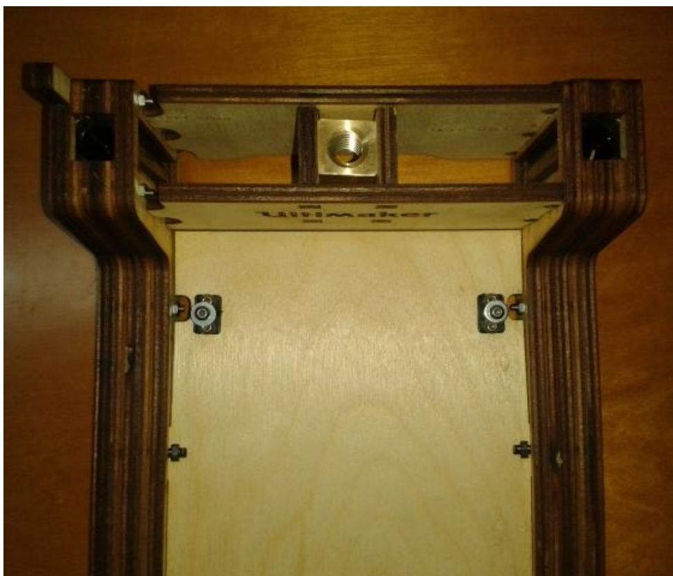
Εικόνα 52 Συναρμολόγηση τραπέζιου εκτύπωσης, άξονας z.
