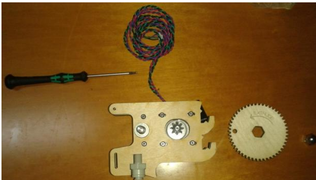
Εικόνα 56 Συναρμολόγηση μηχανισμού διοχέτευσης υλικού στην κεφαλή.
