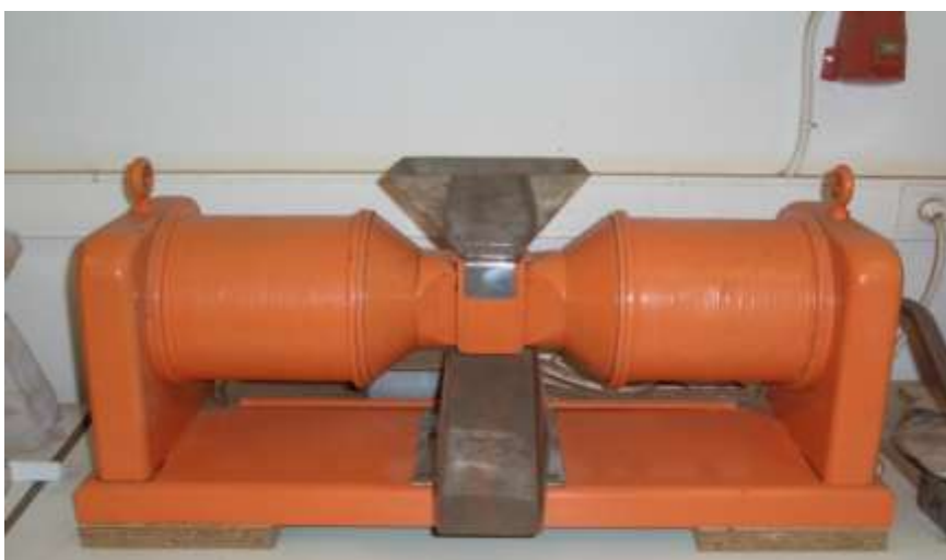
Εικόνα 7: Υγρός μαγνητικός διαχωριστής του Εργαστηρίου Εμπλουτισμού
