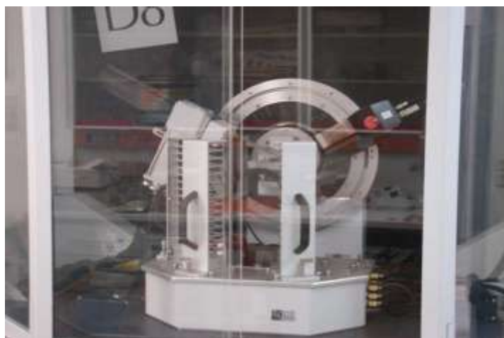
Εικόνα 3: Περιθλασίμετρο ακτίνων-X του Εργαστηρίου Γενικής και Τεχνικής Ορυκτολογίας του Πολυτεχνείου Κρήτης.
