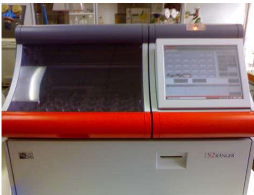
Εικόνα 2: Φασματοσκόπιο ακτίνων -X φθορισμού του Εργαστηρίου Ανόργανης Γεωχημείας, Οργανικής Γεωχημείας και Οργανικής Πετρογραφίας του Πολυτεχνείου Κρήτης
