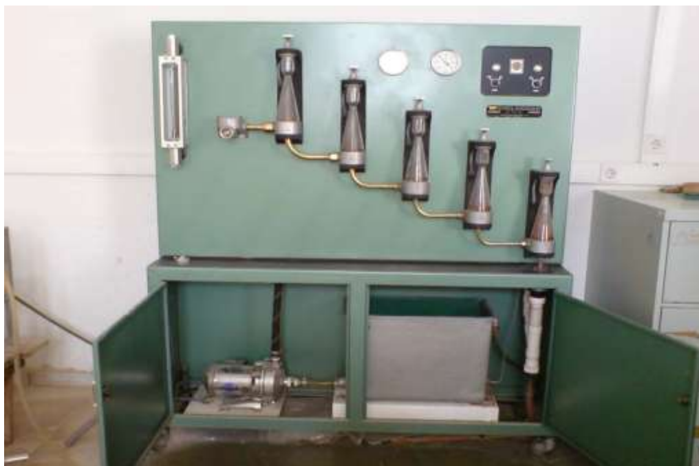
Εικόνα 5: Σύστημα ταξινόμησης λεπτόκοκκου υλικού με υδροταξινομητή Warman
