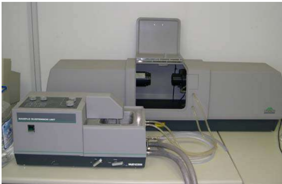
Εικόνα 3: Κοκκομετρικός αναλυτής Laser του Εργαστηρίου Εμπλουτισμού του Πολυτεχνείου Κρήτης.
