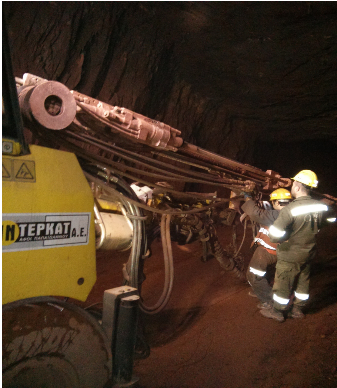
Εικόνα 2-1 (Διατρητικό Jumbo SECOMA τύπου PEC 22)
