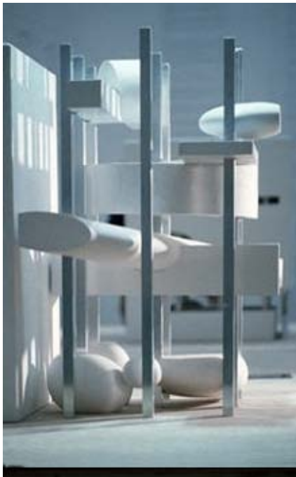
Εικόνα 81 : Άποψη μοντέλου που δείχνει το πλήρες και το κενό. Εννέα πυρήνες, οι οποίοι θα φέρουν διάφανους κλωβούς για εννέα ανελκυστήρες που θα οδηγούν στους δημόσιους χώρους
