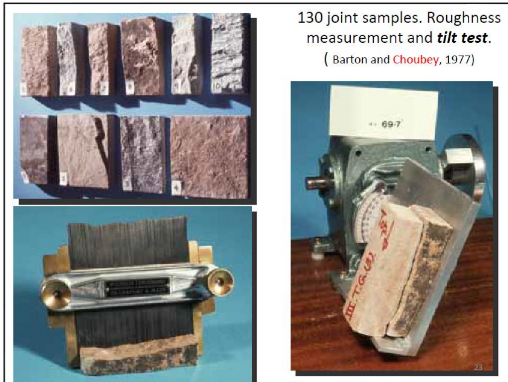
Εικόνα 4.9 Μέτρηση της τραχύτητας και της μέγιστης γωνίας τριβής ασυνέχειας με τη βοήθεια της δοκιμής κεκλιμένου επιπέδου (tilt test) με κλισιόμετρο (Barton and Choubey, 1977).
