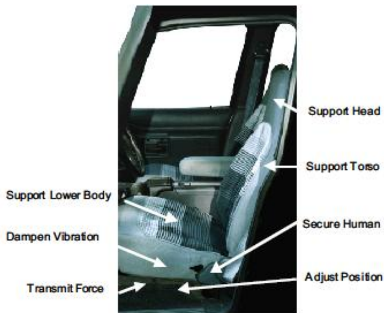
Εικόνα 1 Η δομή ενός καθίσματος αυτοκινήτου
